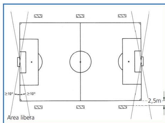
Figura 2.10. Disposizione con tre sostegni laterali
