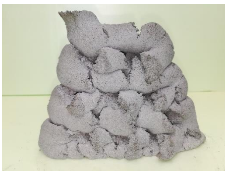
Figura 2.3: Rappresentazione dei miglioramenti avvenuti con viscosizzante V2 nelle paste con additivi A1, A9 e A3.
