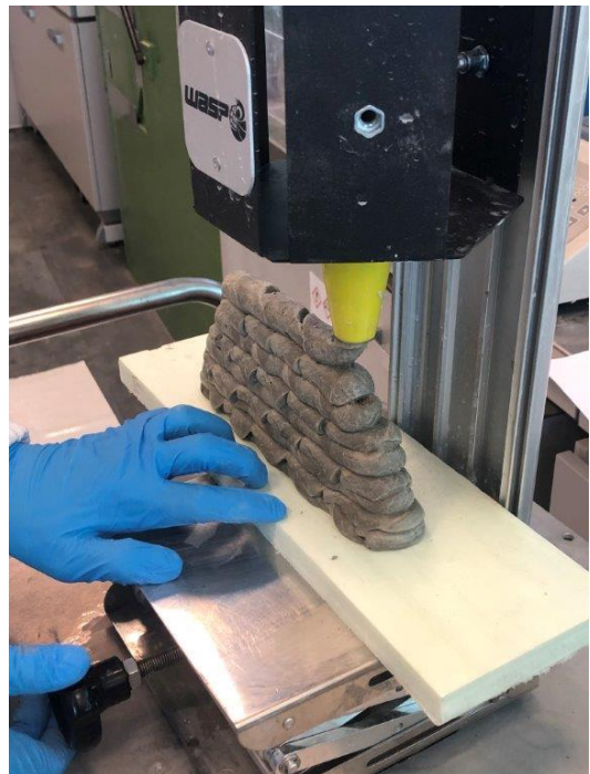
Figura 1.2: A, a sinistra) Rappresentazione schematica della struttura eseguita con la stampa 3D. B, a destra) Immagine del processo di stampa.
