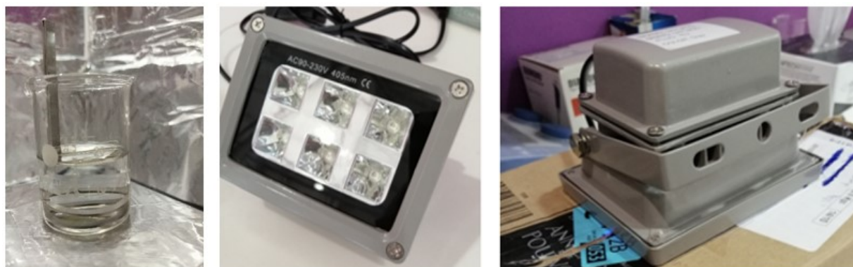
Figura 6.13. A sinistra il prototipo immerso in IPA e PGMEA prima della polimerizzazione mediante la fonte luminosa UV, al centro la lampada UV utilizzata e a destra un'immagine della lampada accesa durante la post-polimerizzazione.
