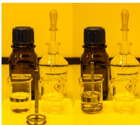
Figura 6.12. Presente in primo piano il substrato di vetro posto nel porta-substrato, in secondo piano le bottiglie contenenti PGMEA e IPA.
