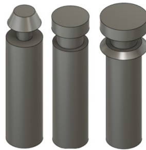
Figura 8.11. Design iniziale (a sinistra), intermedio (al centro) e definitivo (a destra) del supporto dei campioni di gomma.
