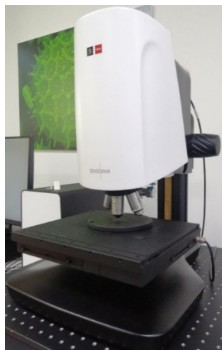
Figura 7.1. Il profilometro ottico Sensofar S Neox.
