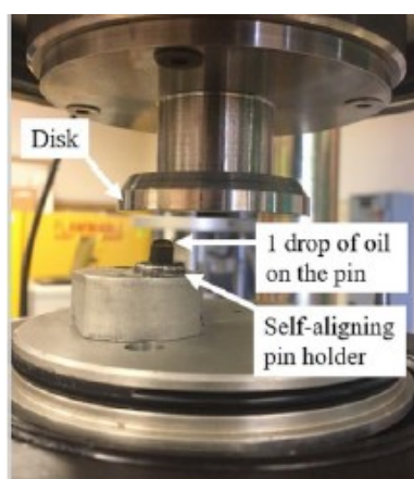
Figura 2.1. Setup utilizzato durante i test tribologici, pin polimerici di ATSP e UHMPE a contatto con un disco d'acciaio (O1 steel) di diametro pari a 50,6 mm [5].
