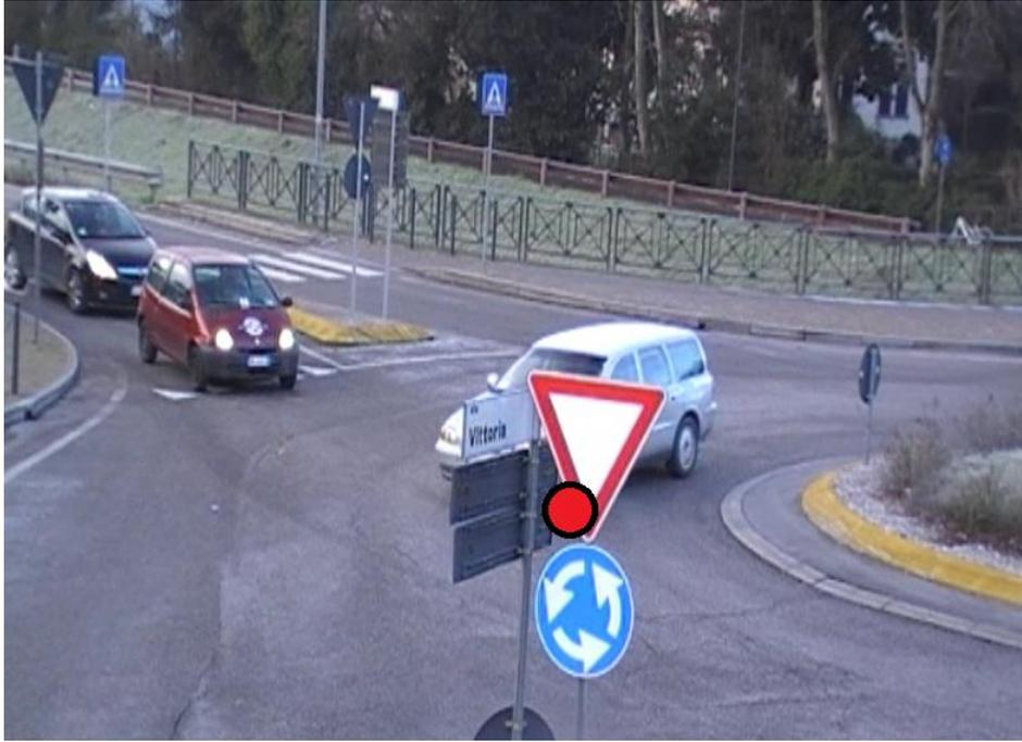
**Fig. 49 - Istante di rilevazione del passaggio dell'ultimo veicolo circolante per il punto di conflitto (gap accettato) (Mirano Taglio Sinistro)**
