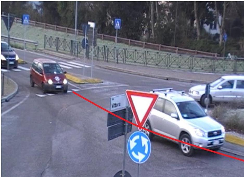
**Fig. 48 - Accettazione del gap da parte del veicolo entrante e relativa manovra di attraversamento (Mirano Taglio Sinistro)**
