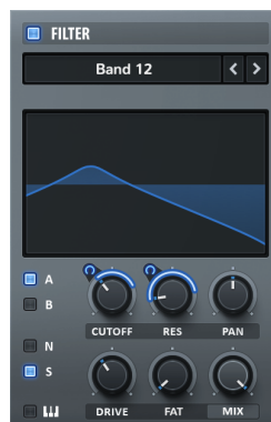
Figura 3.4: filtro passa banda e rispettive manopole.
