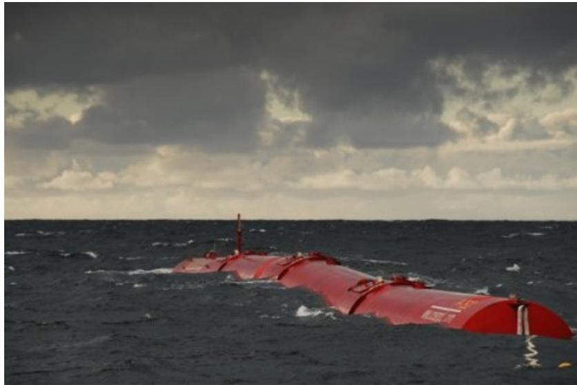
Figura 3.5: Foto di *Pelamis* in mare della Ocean Power Delivery Ltd
