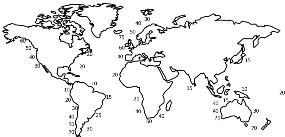
Figura 1: Distribuzione mondiale della potenza delle onde marine in mare aperto per unità di larghezza del fronte d'onda (in kW/m )
