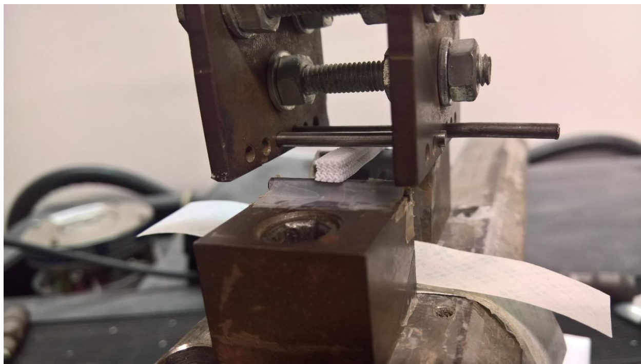
Figura 6.13. Prova di flessione a 4 punti sugli scaffolds di WDE, trattato a 1050 °C.
