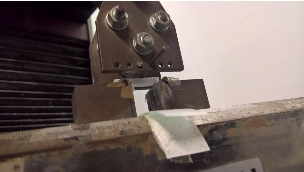
Figura 6.14. Altra visione della prova di flessione a 4 punti sugli scaffolds di WDE, trattati a 1050 °C.
