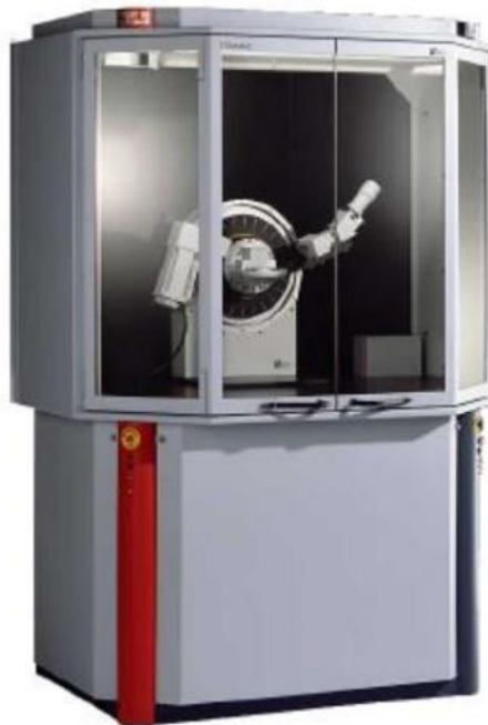
Figura 4.1. Strumento BRUCKER® D8 ADVANCE per diffrattometria di polveri.
