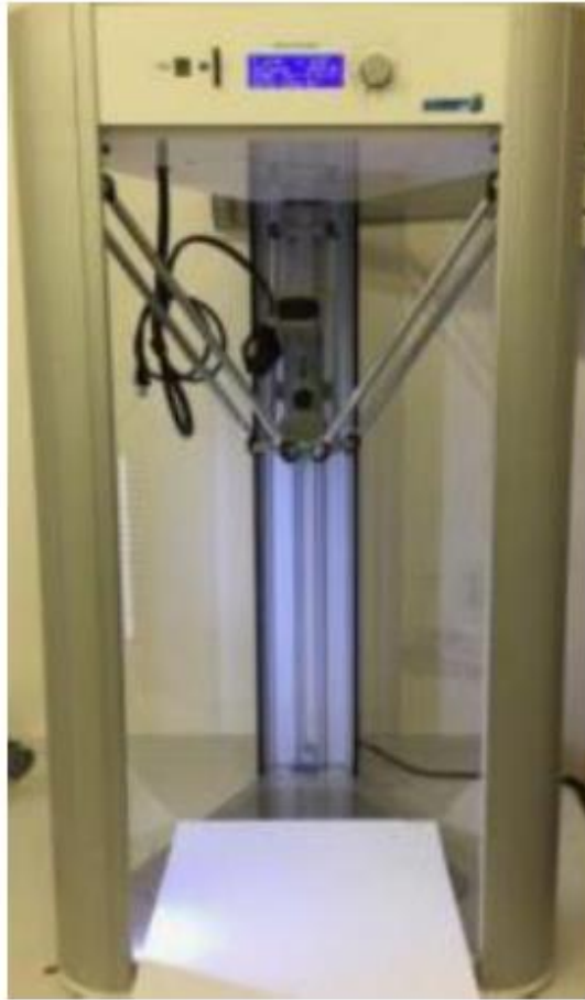
Figura 4.2. Stampante 20x40 Delta Turbo (Wasp, Massa Lombarda, Italia)
