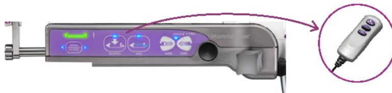
Figura 3.6: manipolo in cui ci sono i comandi per il prelievo
