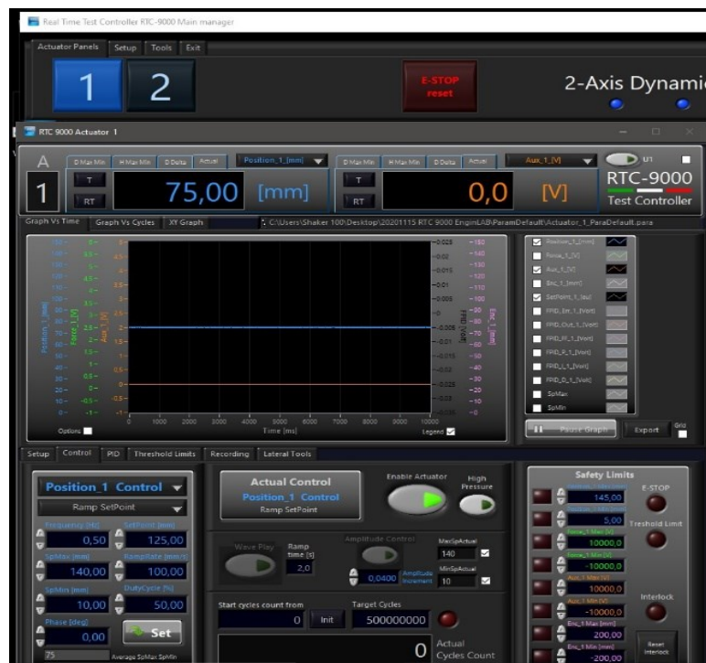
Figura 2.3: interfaccia del software Real Time Test Controller RTC-9000 utilizzato per impostare i parametri della Shaker Table (velocità, direzione e spostamento).
