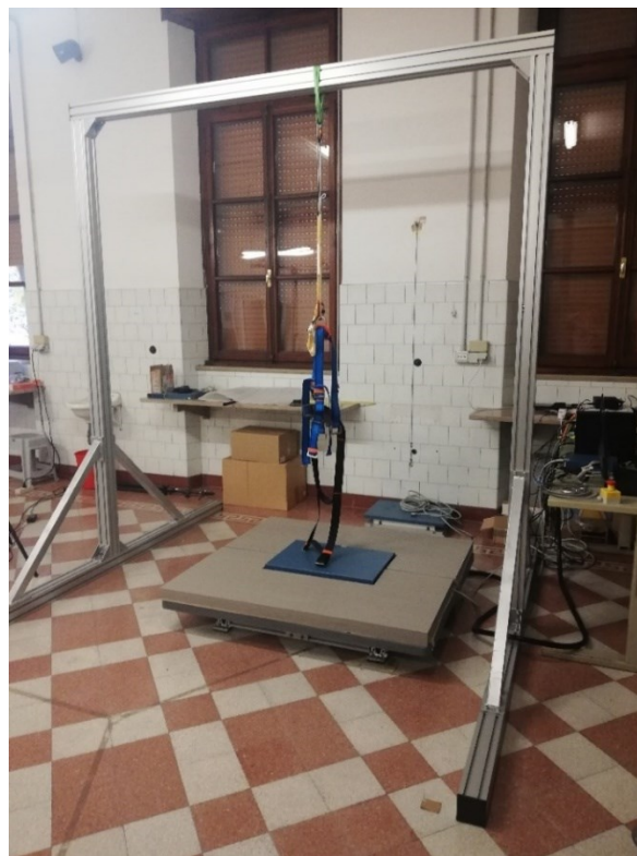
Figura 2.5: Setup sperimentale: Shaker table e portale al il soggetto imbragato viene assicurato
