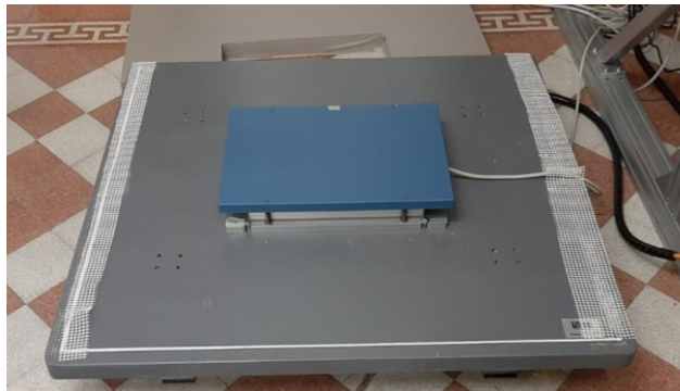
Figura 2.2.: Shaker table sulla quale è stata fissata la pedana dinamometrica. Il cilindro elettroattuato è posizionato al di sotto della pedana grigia e fissato alla stessa.
