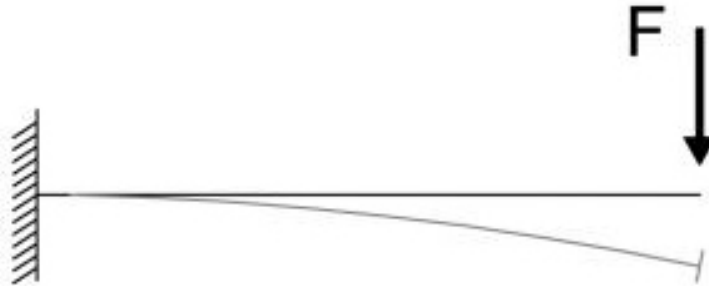
Figura 5.2: Modello di trave incastrata con forza applicata all'estremità, utilizzato in prima approssimazione per effettuare l'analisi di vita a fatica delle palette dei due fan.
