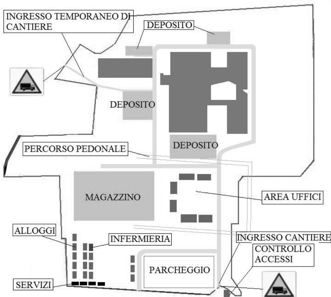
Figura 5.8: Lay-Out cantiere
