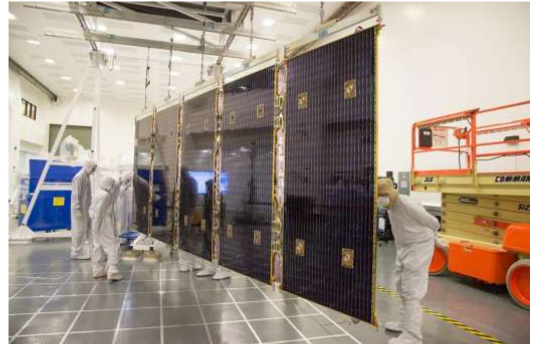
9. Test di qualifica dei pannelli solari
