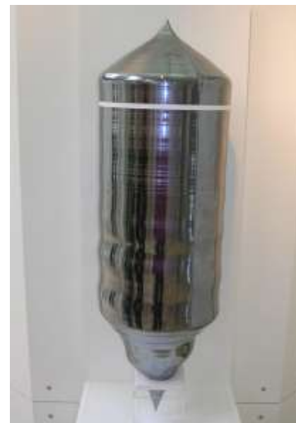
13. Aspetto del silicio monocristallino
