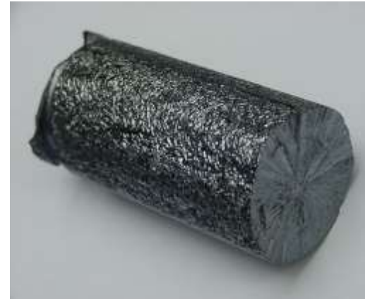
15. Aspetto del silicio policristallino
