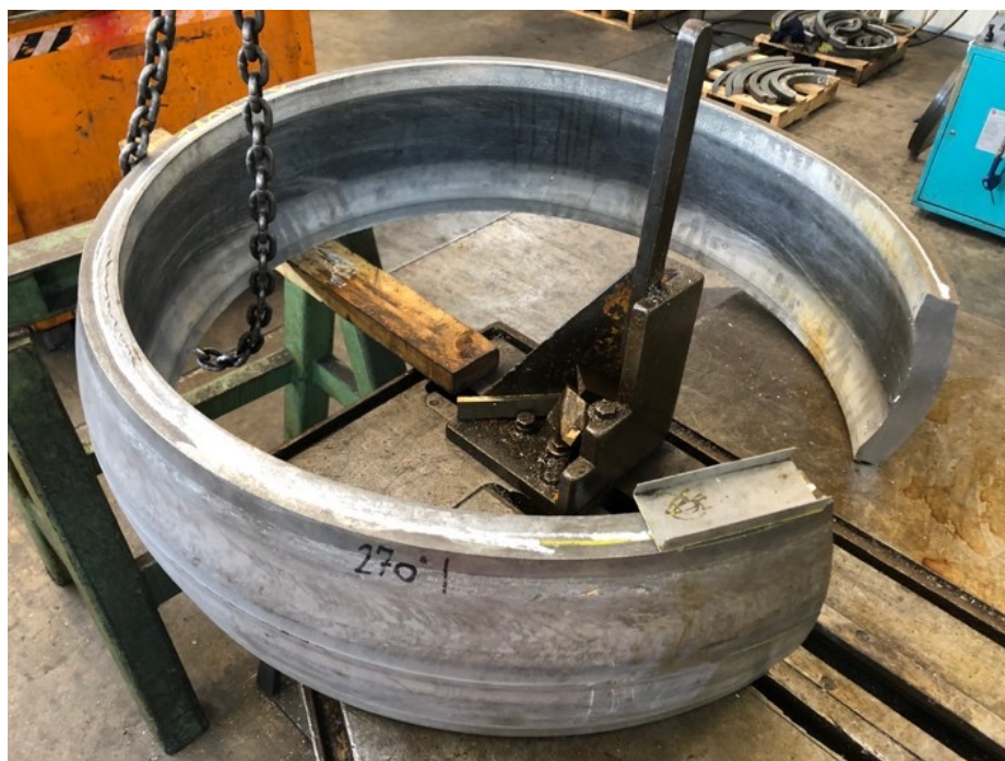
Figura 23 - Anello forgiato sacrificale in alluminio della serie AA6061
