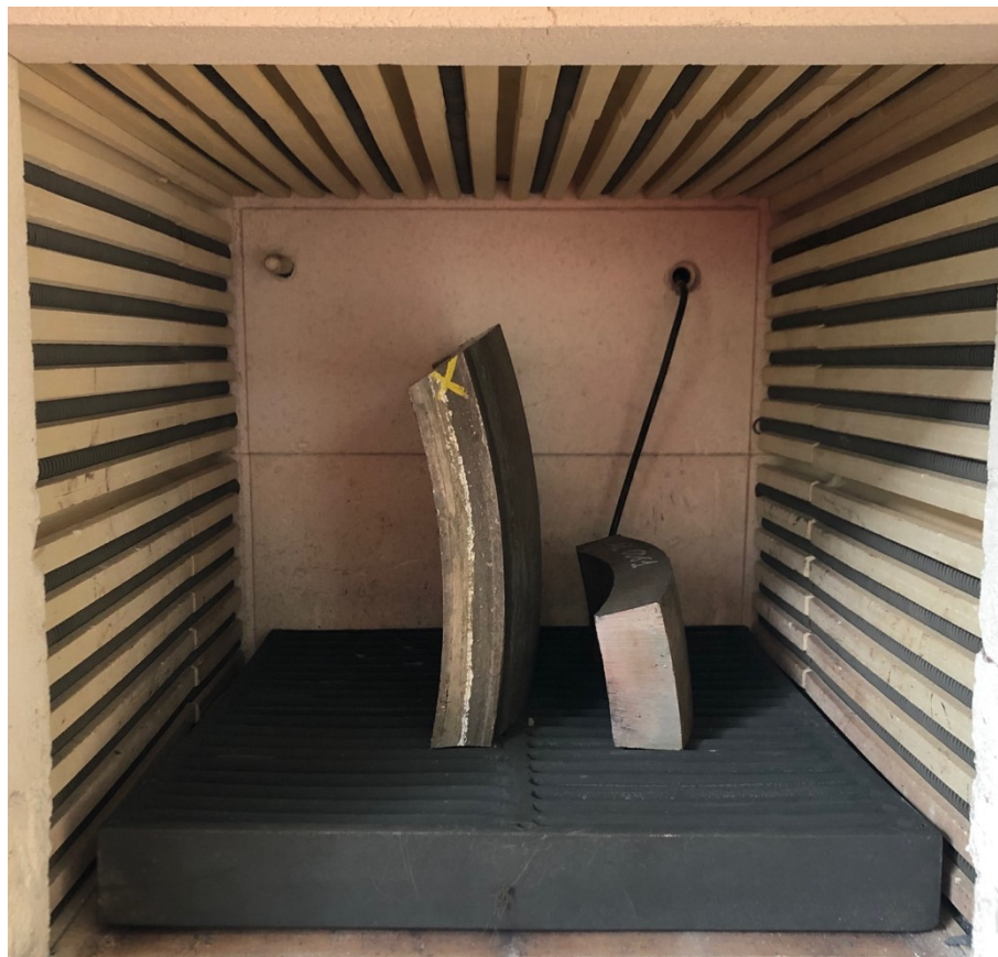
Figura 41 - Inserimento pezzo in forno per solubilizzazione
