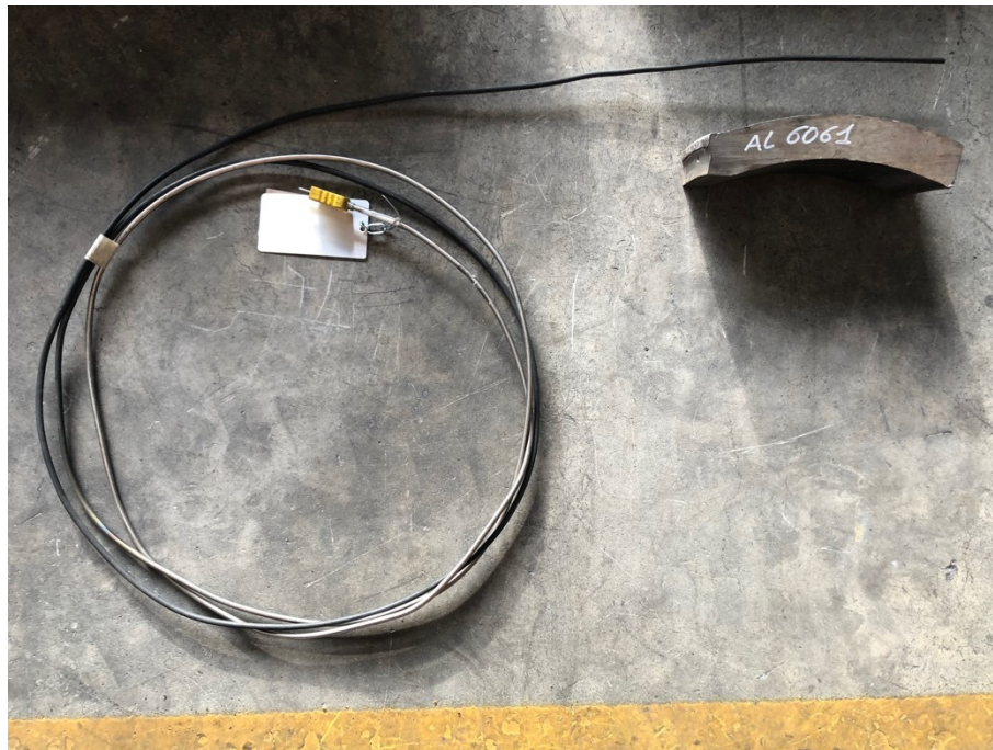
Figura 40 - Termocoppia da inserire nel pezzo campione forato in lega Al6061
