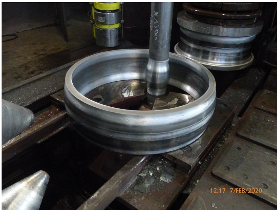
Figura 25 - Pezzo nel laminatoio
