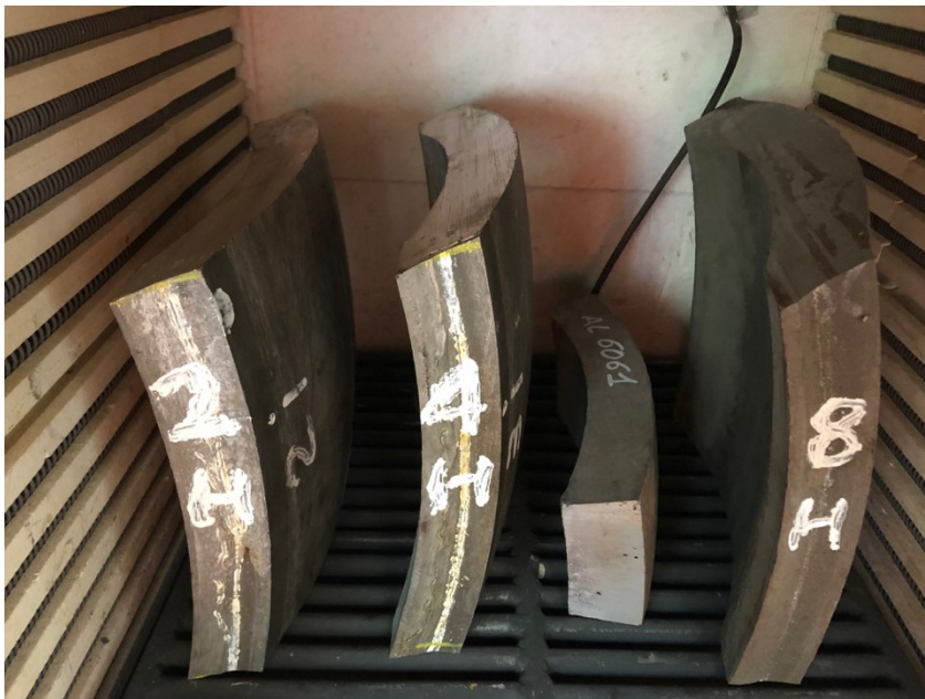
Figura 42 - Pezzi inseriti in forno per l'invecchiamento
