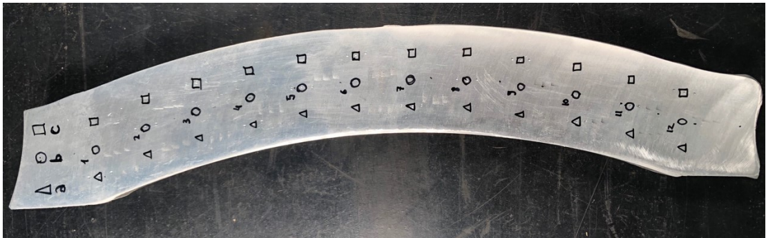
Figura 28 - Prove di durezza Brinell HBW2,5/62,5
