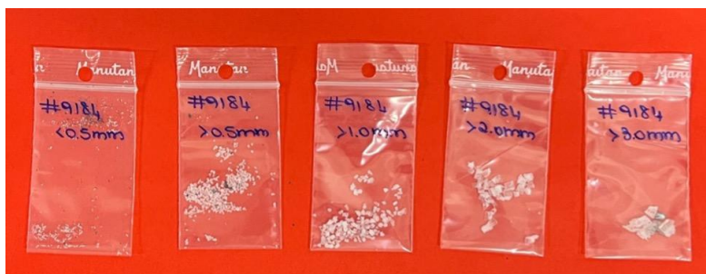
Figura 4.5: Suddivisione in buste di plastica dei campioni in base alla loro dimensione
