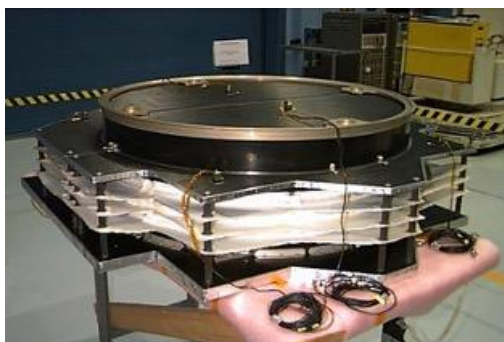
Figura 3.4: Scudo Whipple montato sulla sonda della NASA Stardust
