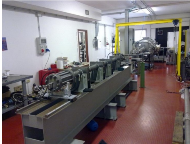
Figura 4.2: Cannone a gas leggero usato per i test
