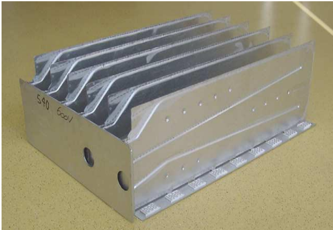
Fig. 4: Rappresentazione grafica del sistema di raffreddamento della batteria Z.E.B.R.A. Z5.
