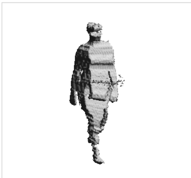
Figura 5.10 – Esempio di volumi “fantasma” nella ricostruzione della visual hull nella zona del bacino.
