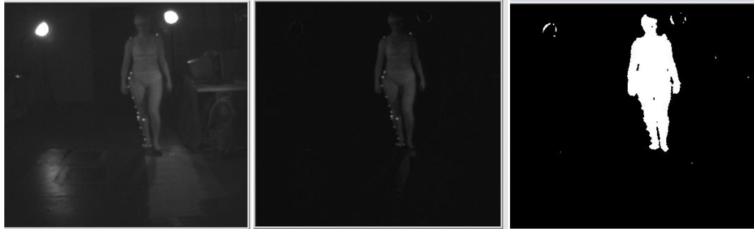
Figura 4.6 – Da sinistra a destra: immagini dello stesso istante di acquisizione del soggetto in laboratorio, del soggetto su uno sfondo nero, della silhouette del soggetto.
