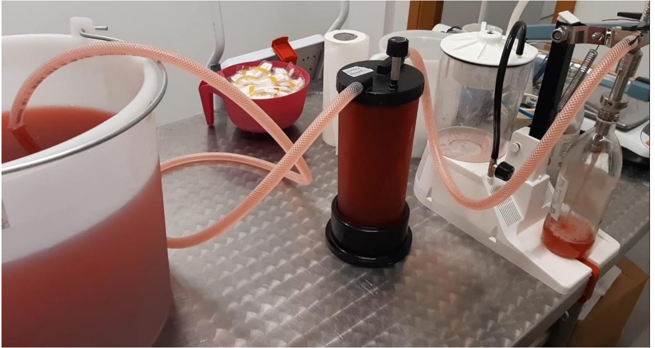
Figura 2 sistema di filtrazione assemblato a sx il tubo di pescaggio e a dx il tubo in uscita con il filtrato. Al centro l'alloggio per il filtro.
