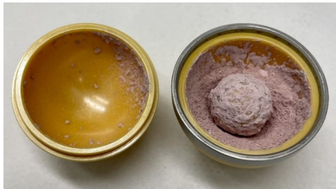
Figura 12: Incrostazioni di polveri dopo il primo ciclo di macinazione
