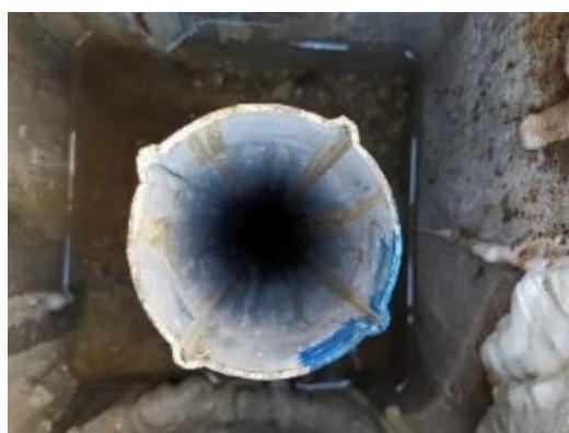
Figura 3.3: Immagine di dettaglio della sezione di un tubo inclinometrico con scanalature, ricavata dal sito https://www.snpambiente.it/wp-content/
