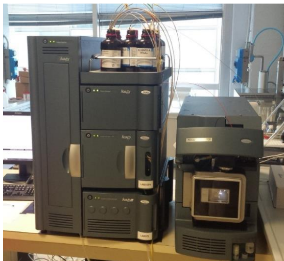
Figura 3.5: Strumento LC-MS/MS in utilizzo nel laboratorio di Acque del Chiampo
