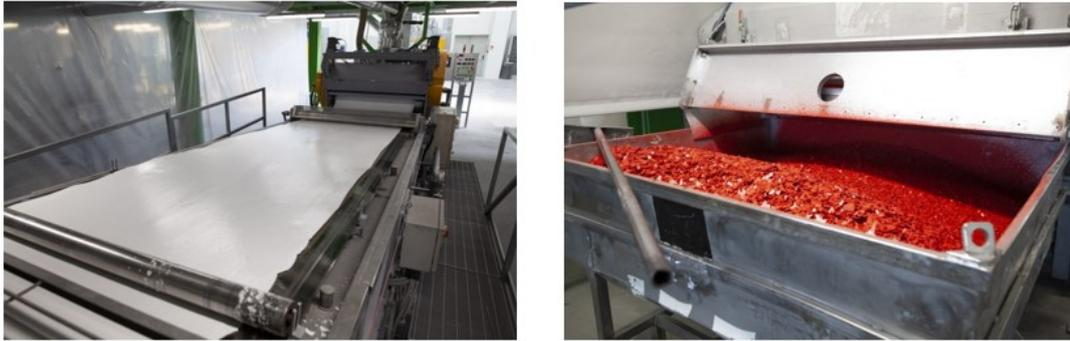
*Figura 2 nastro trasportatore sul quale viene raffreddato il materiale estruso e frantumazione a scaglie. Foto scattate nel reparto Decoral Powder*
