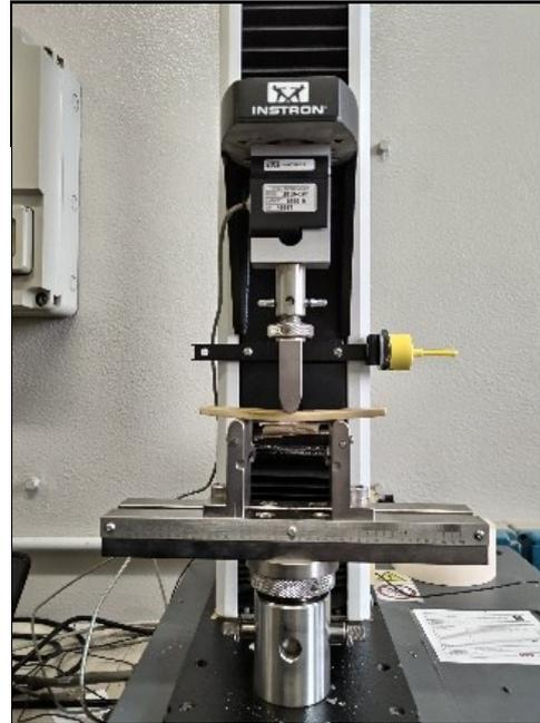
Figura 32 prova di flessione eseguita sui provini in laboratorio
