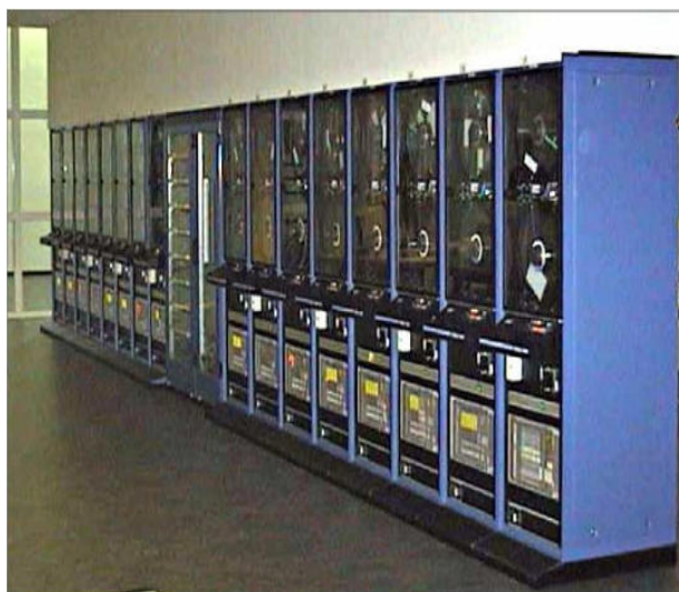
Figura 3.7: Vecchio correlatore a nastro magnetico del sistema VLBI di Medicina
