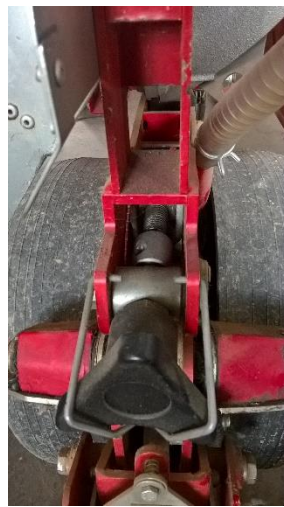
Figura 6.16. Meccanismo a vite che regola la profondità di semina.
