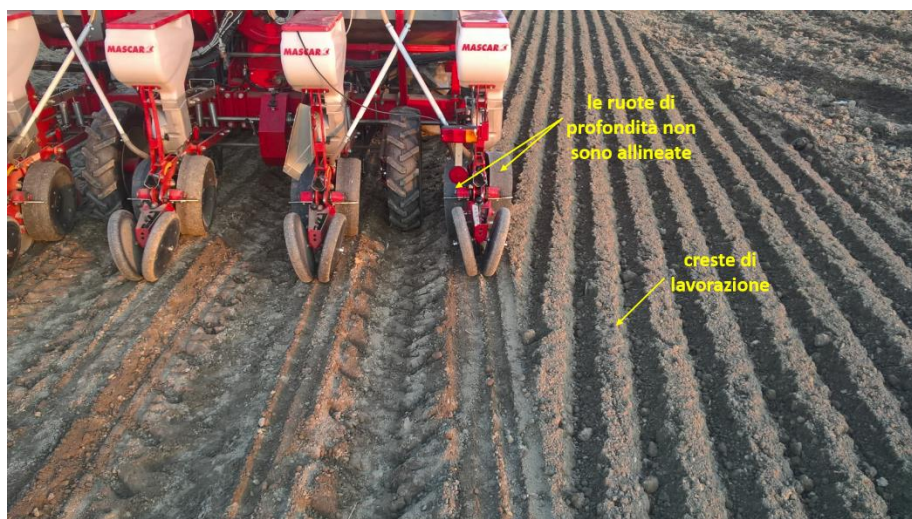
Figura 7.2. Creste di lavorazione derivanti dalla preparazione del letto di semina. Come si osserva in figura le ruote di profondità dell'unità di semina esterna (unità esposta alle irregolarità del terreno) non sono allineate. Questo fenomeno è imputabile alle irregolarità del suolo.
