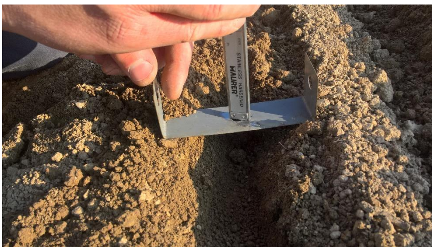
Figura 6.22. Misurazione della reale profondità di semina alla quale la seminatrice ha effettivamente depositato la semente.
