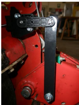
Figura 6.13. Sensore di movimento angolare collegato all'apparato chiudi solco tramite apposito braccetto.
