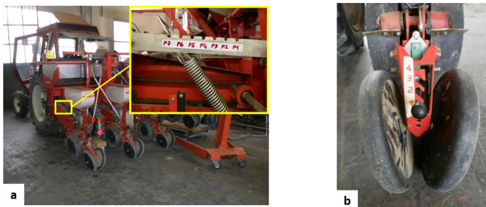
Figura 6.10. a) scala del meccanismo di appesantimento dell'unità di semina e b) scala del meccanismo di regolazione del carico esercitato dal gruppo chiudi solco.
