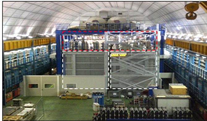
Figura 1: ICARUS T600 ai LNGS: si possono vedere i due moduli del rivelatore (tratteggio bianco) e la zona dove sono montate le componenti dell'elettronica di acquisizione (tratteggio rosso).
