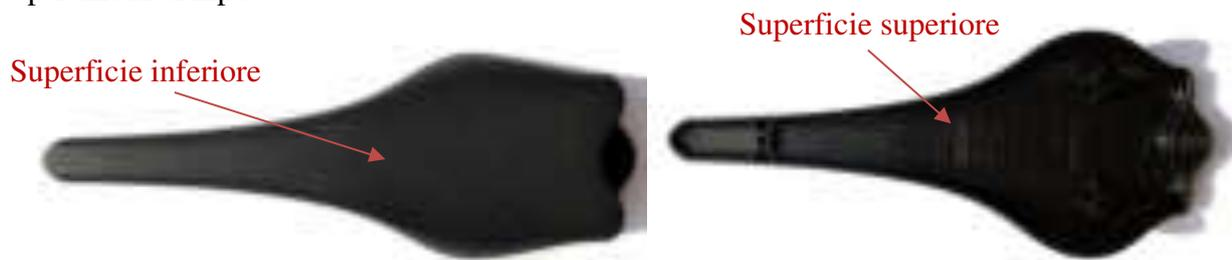
Figura 53. Immagine reale della sella mediante stampaggio ad iniezione tradizionale (vista superiore ed inferiore)
