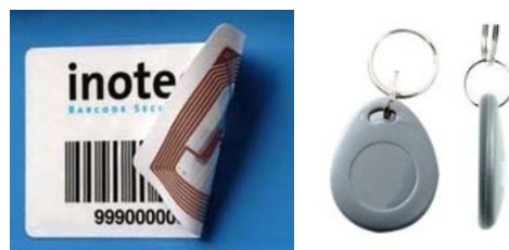
Figura 1.2: Due TAG RFID integrati: in un etichetta stampata e in un portachiavi
