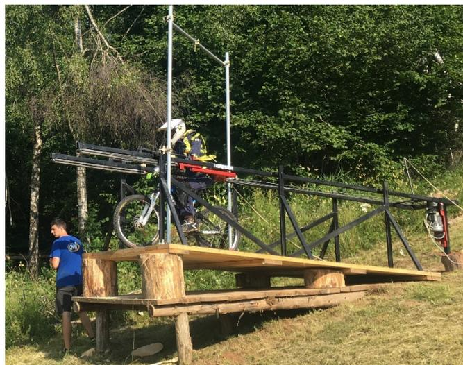
In questa versione, si sono creati 2 alloggiamenti nella parte anteriore del carrello dove viene fissato il manubrio della bici, e da questa zona si va ad applicare la forza dovuta all'accelerazione. Per sostenere il manichino durante la fase di lancio si va a collegare una fascia facendola passare dietro la schiena, in modo tale che il baricentro del manichino sia all'interno della zona di carico.
