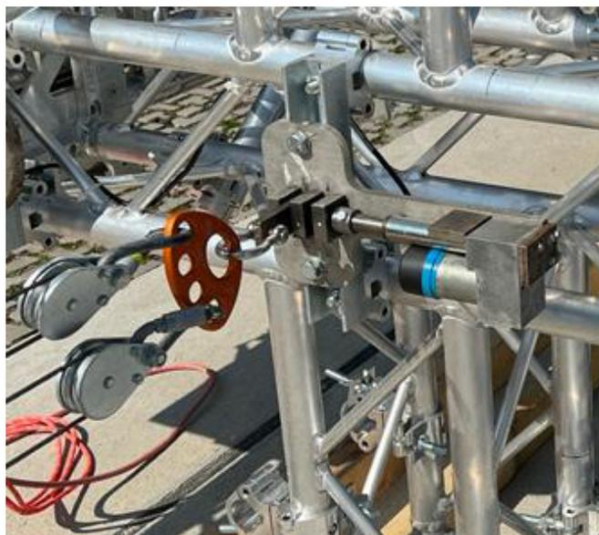
Figura 0-23Fissaggio verricelli centrali al carrello
