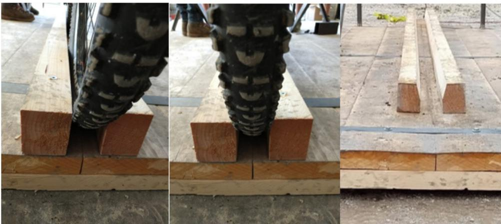
*Figura 0-31Guida ruota bicicletta*
