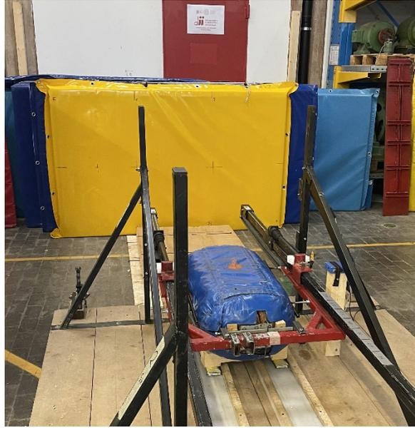
*Figura 0-39 Layout caratterizzazione materassi*
