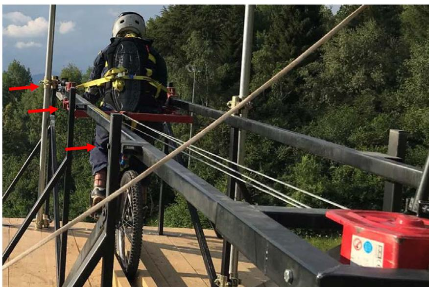
*Figura 0-26Punti di fissaggio delle guide laterali*
