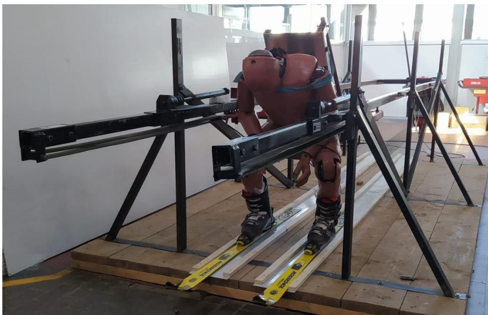
*Figura 0-10 Configurazione Catapulta in versione 1.2*
