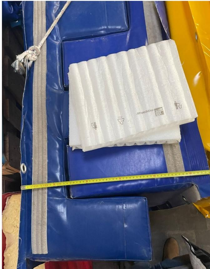
*Figura 0-5 Materasso grecato utilizzato nelle prove "none"*
