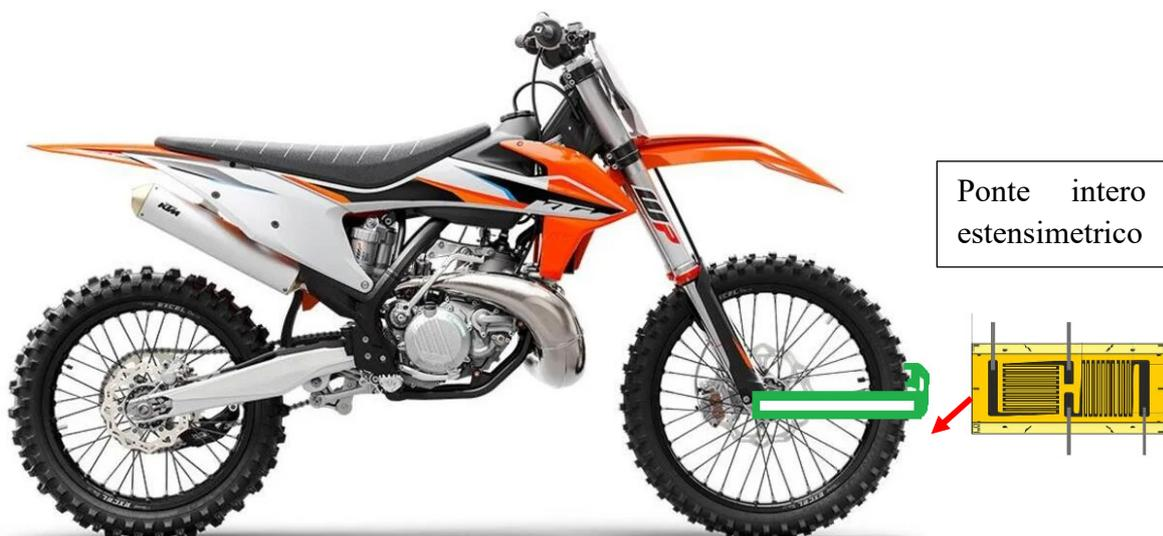
Figura 0-48 Disposizione ponte estensimetrico
