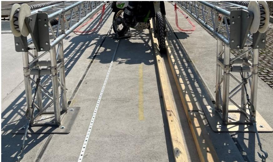
*Figura 0-38 Guide in legno per direzionamento ruota anteriore*
