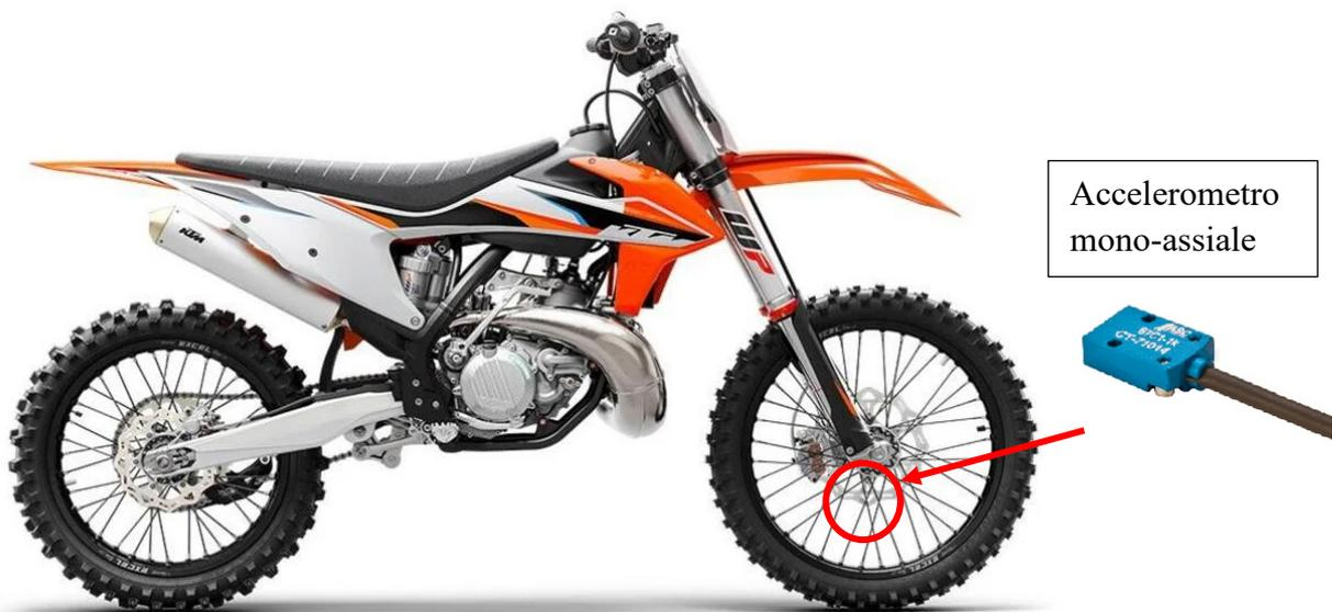
Figura 0-47 Disposizione accelerometro anteriore
