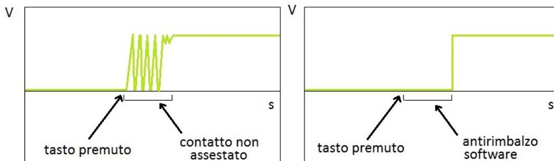
Fig. 2.5 Diagramma che evidenzia il problema del rimbalzo della tensione.
