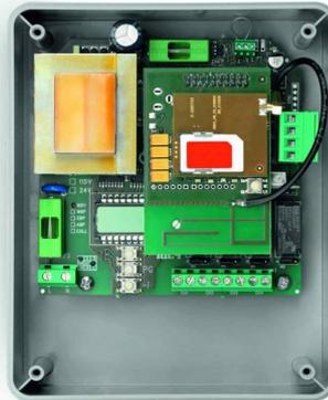
Fig. 1.4 Centralina per il comando da cellulari.
