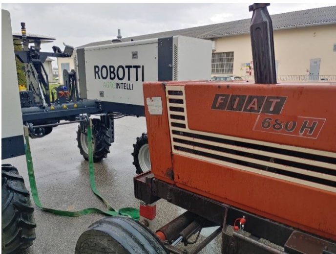
Figura 22: Applicazione della cinghia con dinamometro tra Robotti 150d e trattoria agricola per le prove di slittamento
