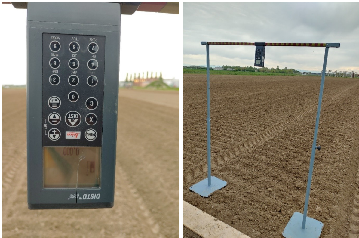
Figura 28 Lettore laser Disto pro4 Leica con relativa barra per le misurazioni
