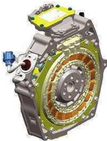
Fig. 4.12 Il motore elettrico in uso nella Honda Civic.
