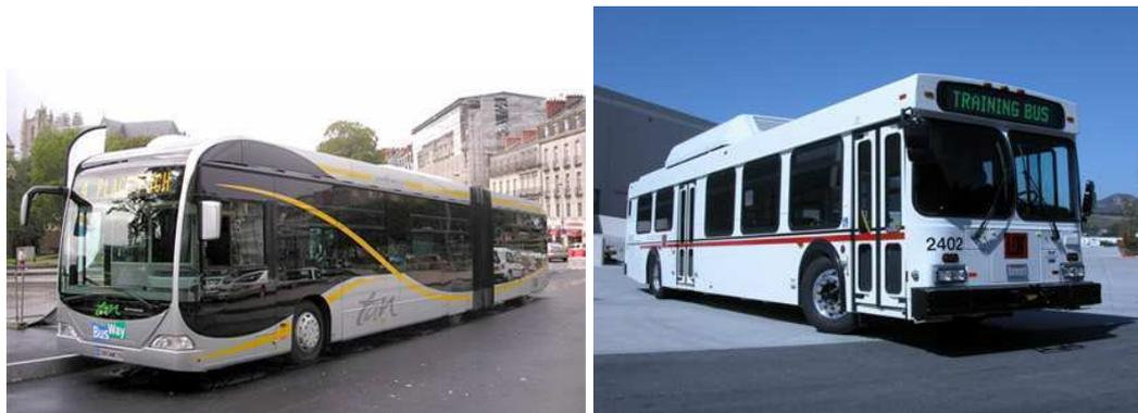
Figura 2.16 Due esempi di ibrido serie; il prototipo di Mercedes (a sinistra) e quello di ISE Corporation (a destra).
