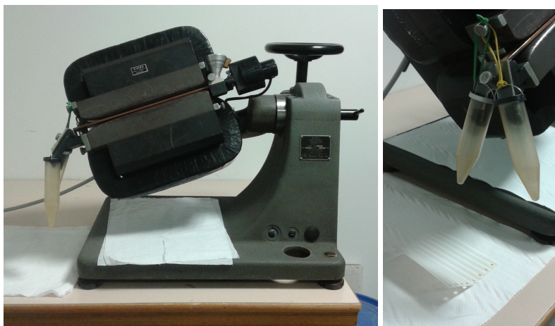
Fig 4.5 – Separatore magnetico Frantz, dipartimento di Geoscienze dell’Università di Padova.
