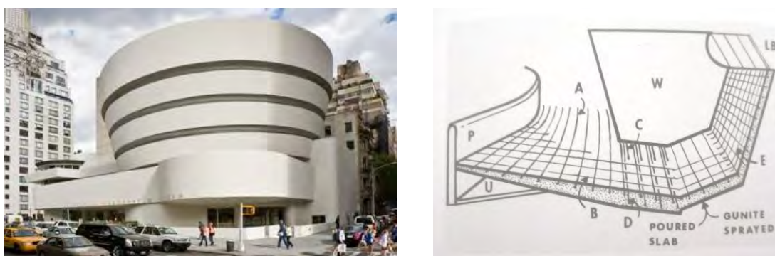
Figura 8: A sinistra veduta esterna del museo, a destra schema della sezione della rampa.
