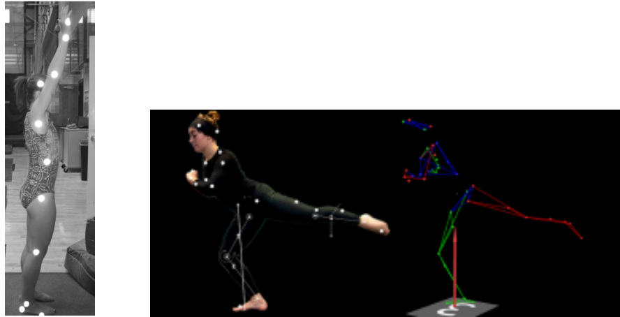
Figura 1.10: a sinistra: posizione dei marker su una ginnasta. A destra, sistema stereofotogrammetrico 3D optoelettronico.
