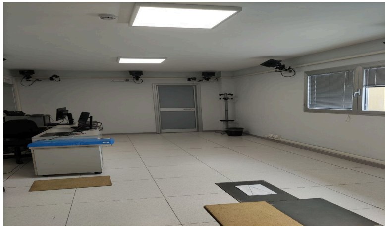
Figura 1.6: Laboratorio con sistema stereofotogrammetrico, UNIPD
