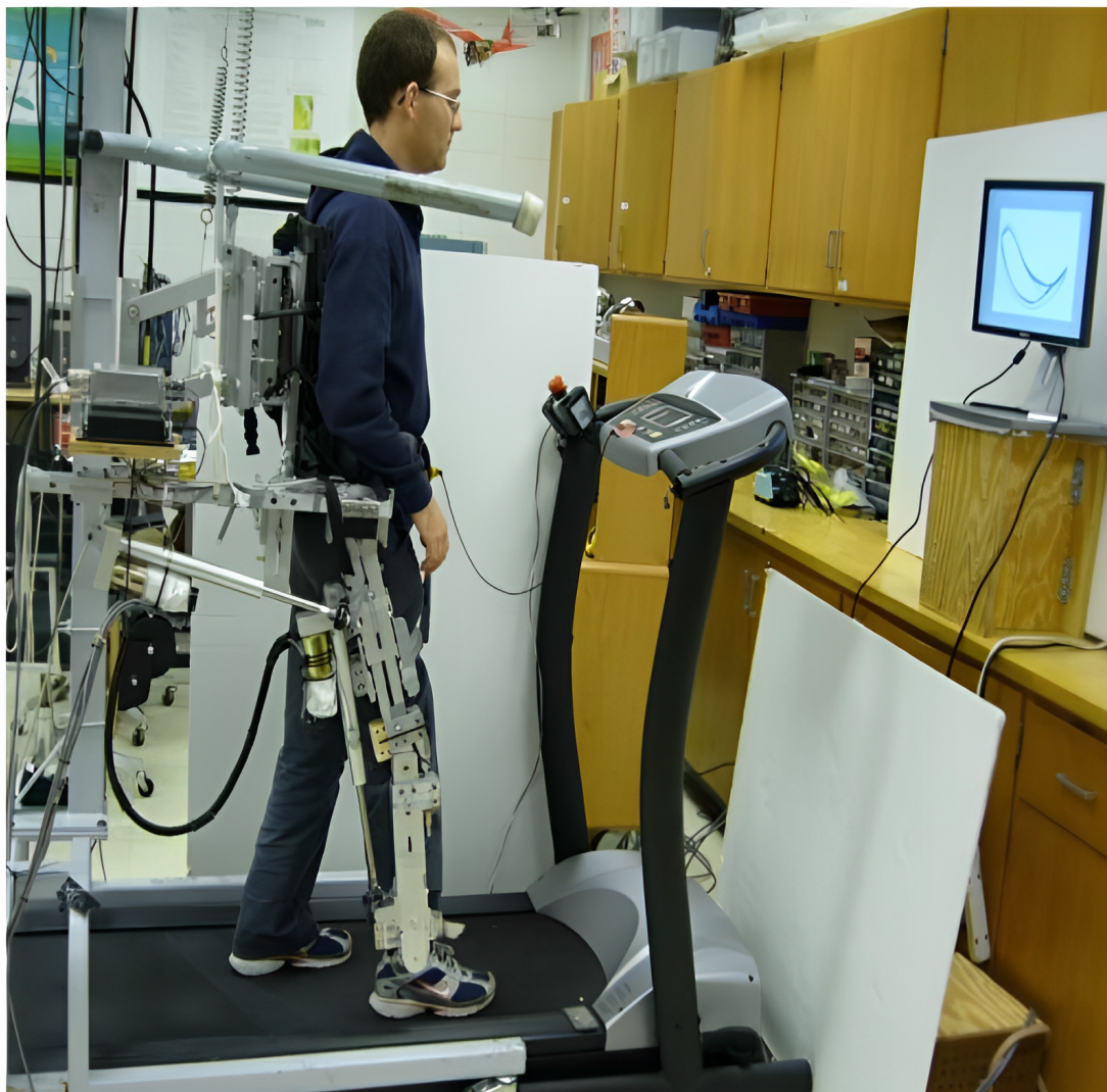
Figura 1.3: Esoscheletro ALEX per la riabilitazione dell'arto inferiore
