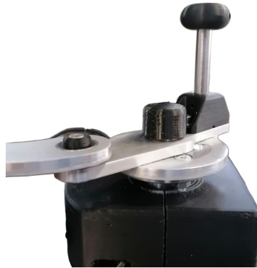
Figura 2.8: Meccanismo di sgancio a molla per cambio configurazione
