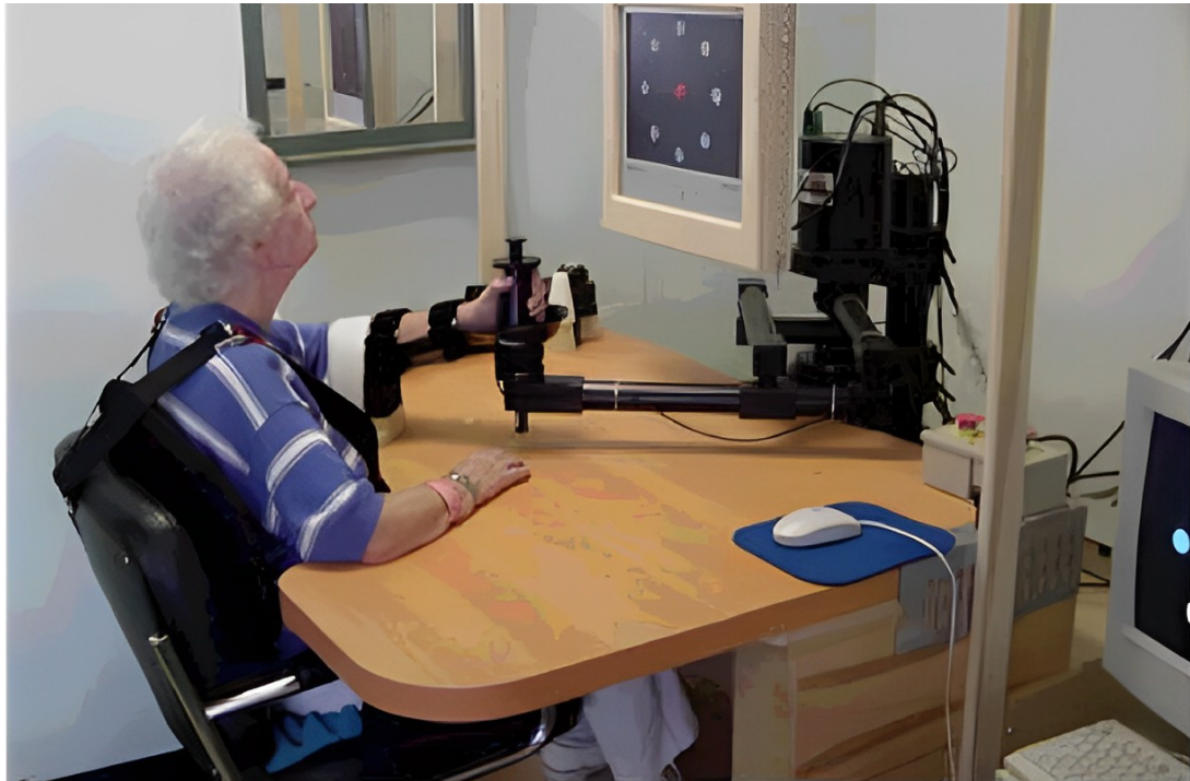
Figura 1.4: Robot MIT-MANUS per la riabilitazione dell'arto superiore
