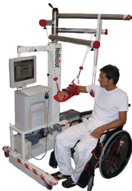
Figura 1.5: Robot NeReBot per la neuroriabilitazione dell'arto superiore
