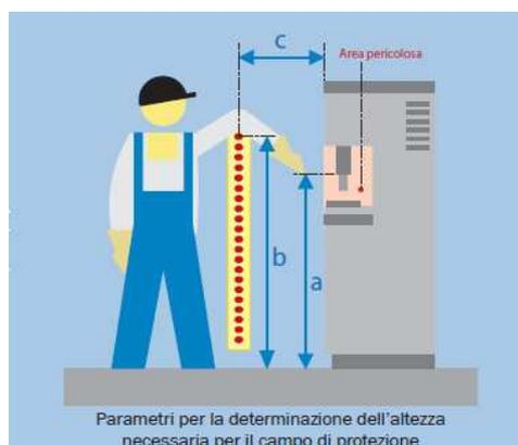
Figura 1-14: Altezza campo protettivo(*b*), altezza area pericolosa (*a*) e distanza area pericolosa (*c*). [9]
