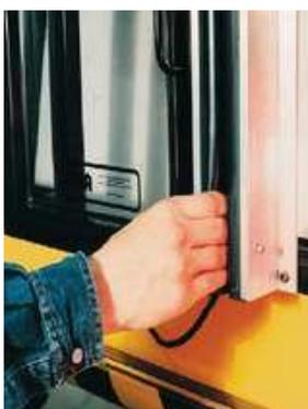
Figura 2-8: Un bordo di sicurezza impedisce lo schiacciamento della mano dell'operatore. [2]
