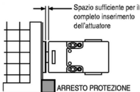
Figura 3-12: Arresto meccanico di un interruttore con attuatore. [2]
