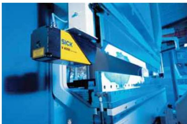
Figura 1-3: Sistema visione sicura per pressa piegatrice. [9]
