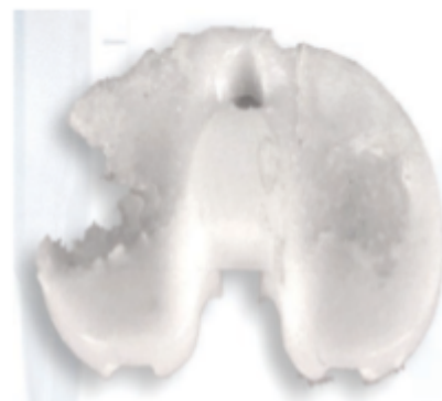
Fig. 15 Componente di polietilene usurata [6]
