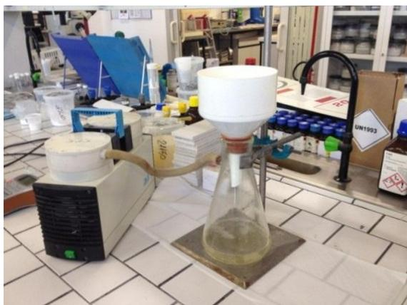
**Figura 2.4.** Attrezzatura per la filtrazione
