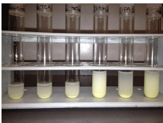
I solventi con  $NH_3$  e TEA sono stati inizialmente posti in ultrasuoni, successivamente sono state aggiunte le particelle di Titania; infine è stato effettuato un ulteriore bagno ad ultrasuoni.
