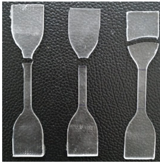
Figura 1.4. Configurazione dei provini seconda normativa dopo aver eseguito i test di rottura.
