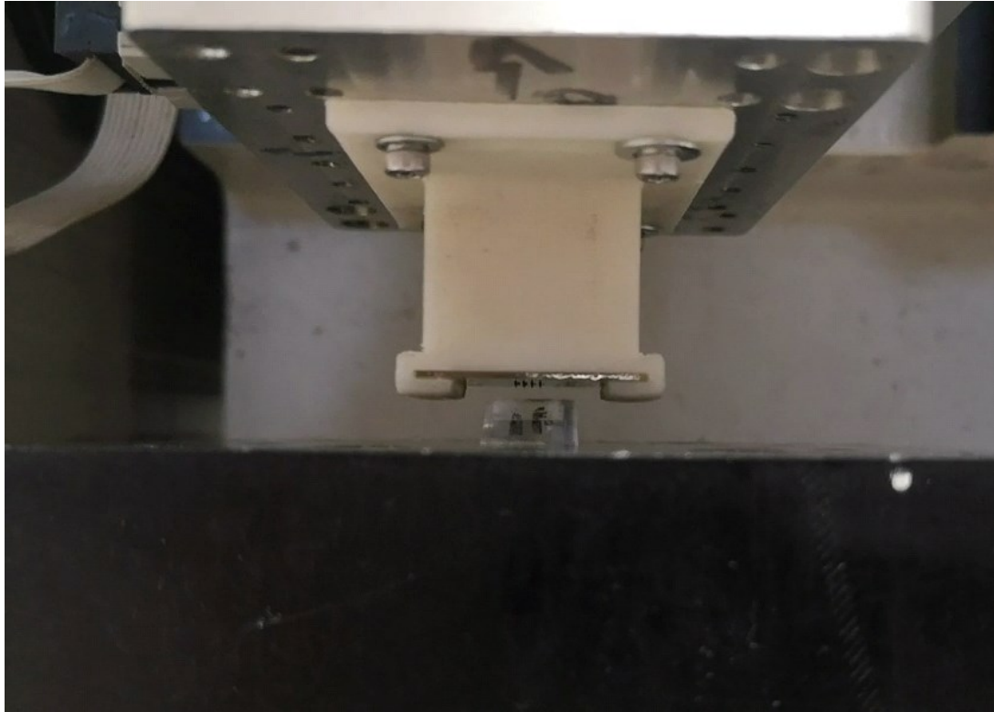
Figura 2.14. Configurazione di una prova di inserzione con gli aghi su PDMS 5:1.
