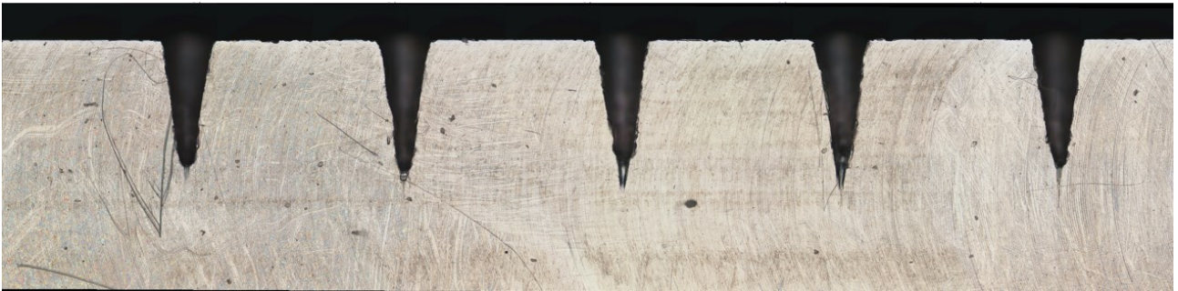
Figura 2.17. Foto al profilometro ottico di fori con diametro 300 \mu m.
