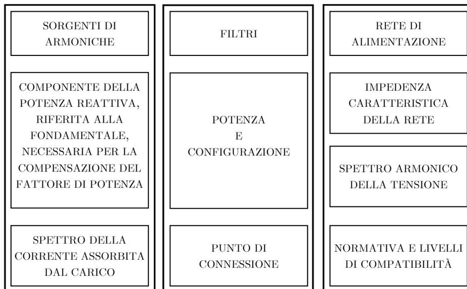
FIGURA 3.32 PARAMETRI TIPICI DA CONSIDERARE NELLA FASE DI PROGETTAZIONE DI UN FILTRO
