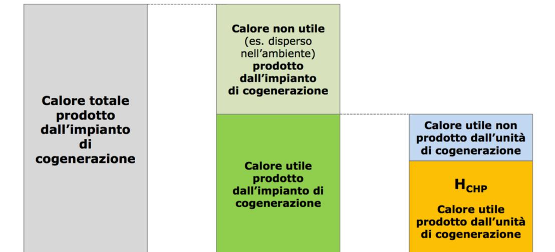
Figura 44 – Calore totale prodotto dall'impianto: le tre possibili componenti
