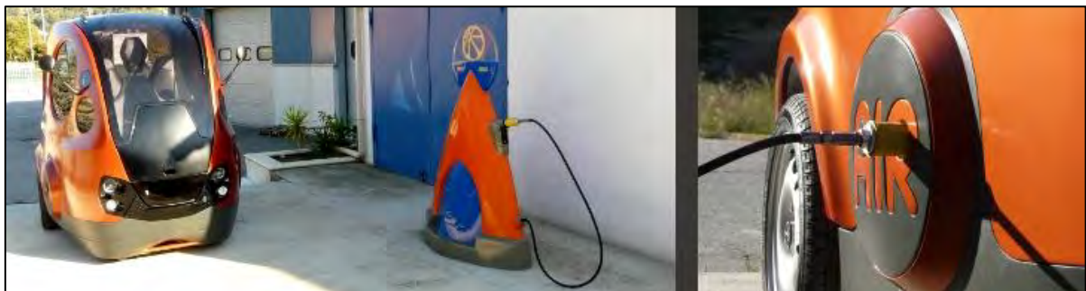
Figura 5-17 Esempio di stazione di rifornimento per veicoli ad aria compressa
