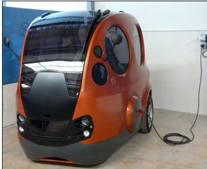
Figura 5-16 Ricarica dei serbatoi a bordo di Airpod tramite compressore interno alimentato dall'energia elettrica proveniente dalla presa di corrente
