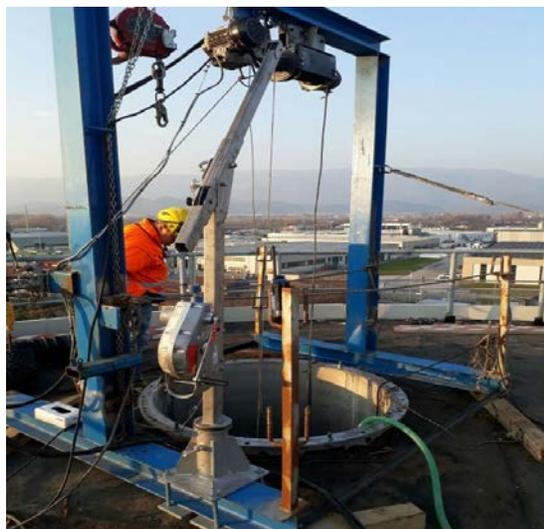
*Figura 43 - Cavalletta di supporto per l'ingresso/uscita dall'alto*
