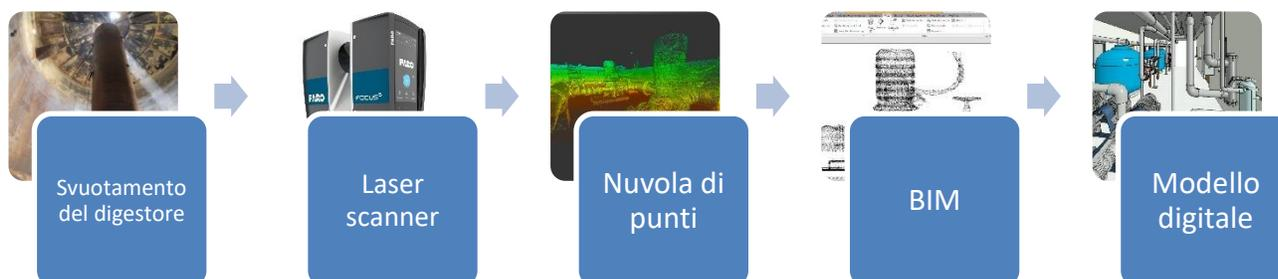
Figura 47 - Processo per la creazione del modello digitale
