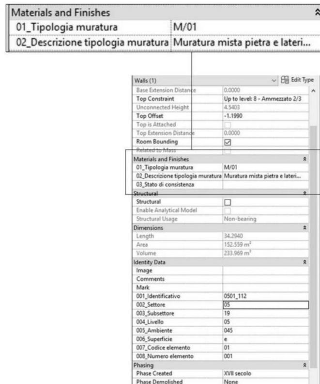
Figura 18 - Tabella con le caratteristiche del muro che viene selezionato
