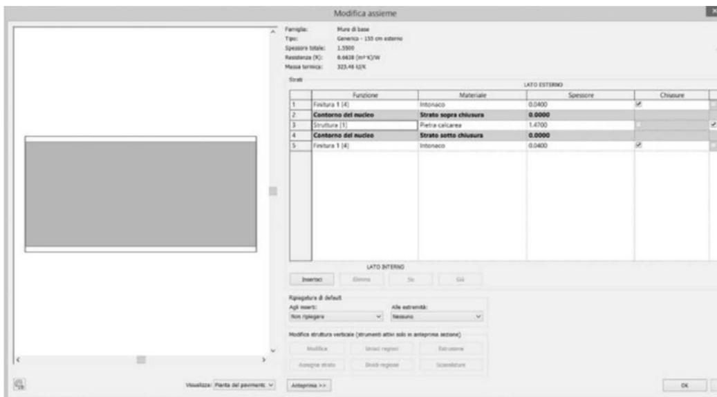
Figura 17 - Tabella che si genera selezionando un muro di un edificio
