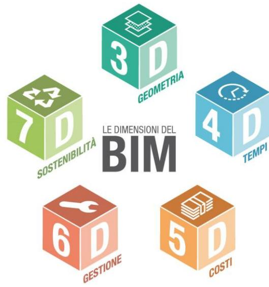
Figura 12 - Le dimensioni del BIM
