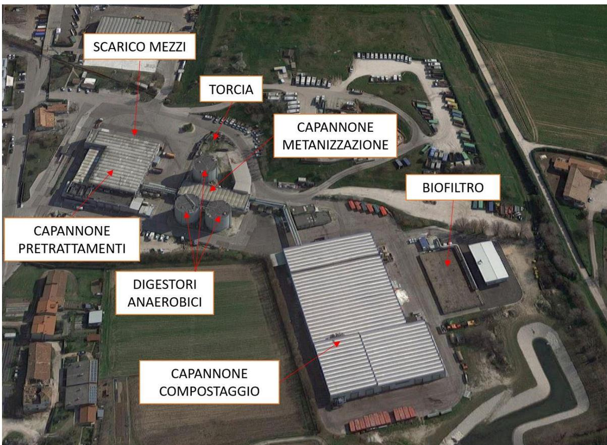
Figura 31 - Ortofoto dell'impianto di gestione anaerobica e di compostaggio del quartiere Prè a Bassano del Grappa
