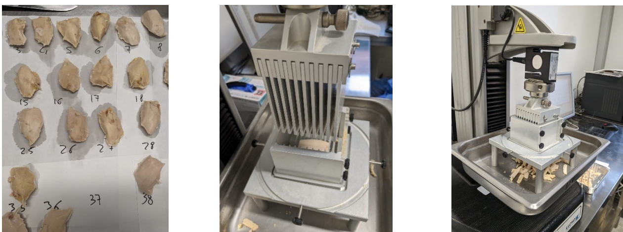
Figura 7. Campioni di P. major dopo la cottura da utilizzare per misura tenerezza (a sinistra), dinamometro Ls5 durante le misurazioni (a destra).
