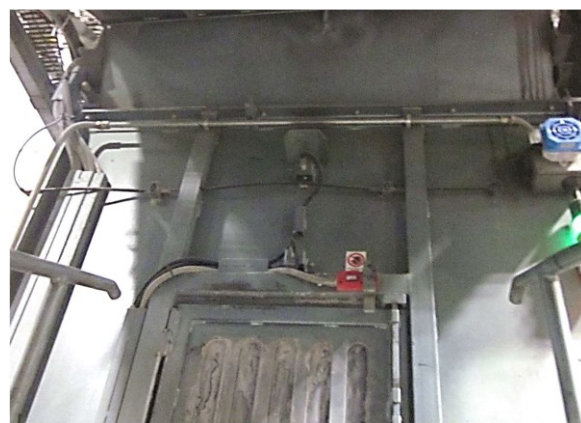
Figura 14 – sensore di troppo pieno collegato al nastro trasportatore
