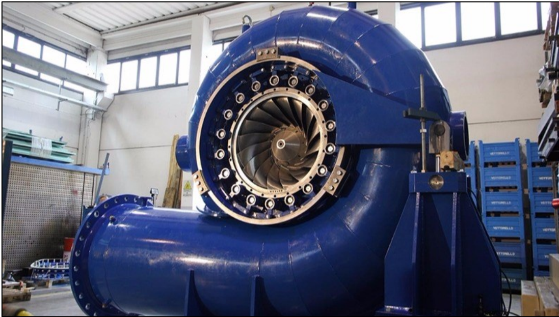
Figura 2.3: Turbina Francis. Fonte: https://www.vettorelloenergy.it/centraliidroelettriche.html
