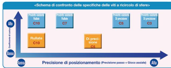
Figura 4.15: Classe di precisione delle viti senza fine a ricircolo di sfere [33].
