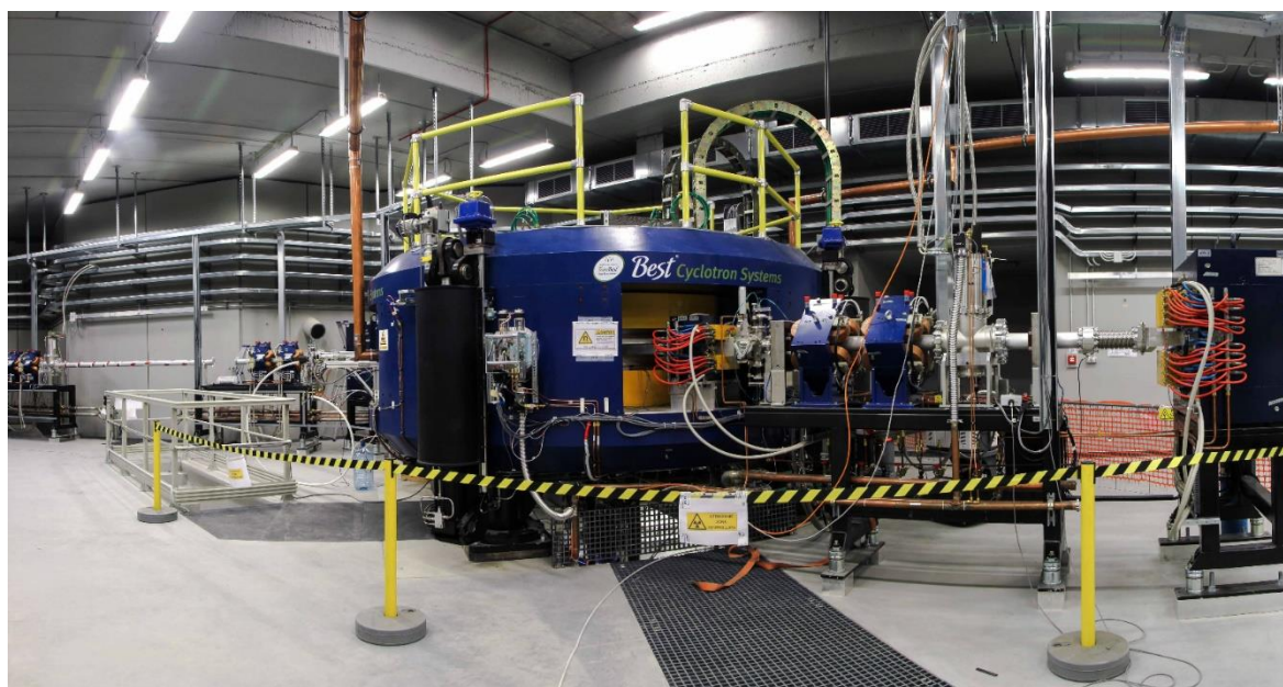
Figura 2.7: Ciclotrone Best 70p della Best Cyclotron® e disposizione delle due uscite indipendenti [6].
