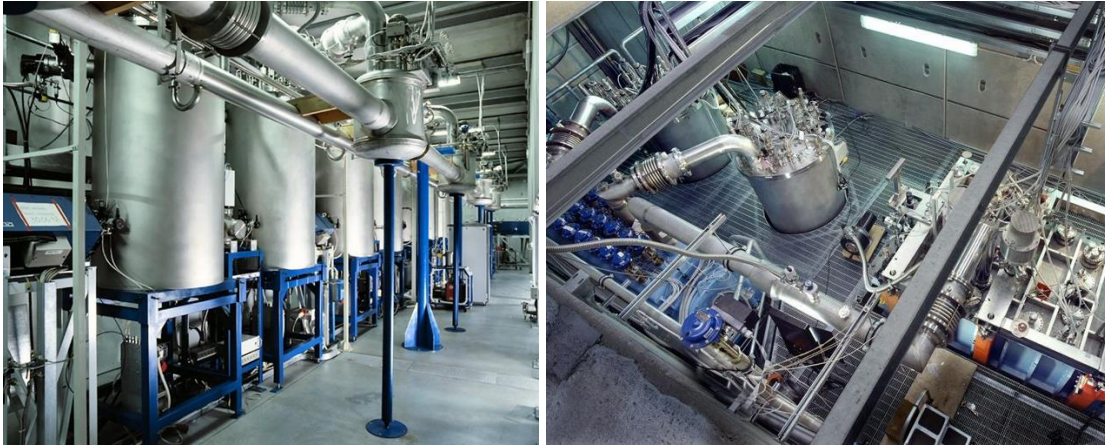
Figura 2.17: Acceleratori ALPI (a sinistra) [8] e PIAVE (a destra) [9].
