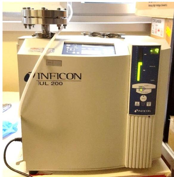
Fig. 4.28. Leak detector INFICON UL 200 utilizzato con installata nella parte superiore il sistema di chiusura.
