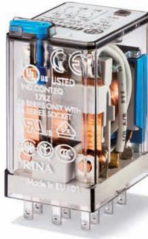
Fig. 3.25. Relè monostabile modello 55.33 della FINDER. Questo relè deve essere montato su uno specifico zoccolo serie 94 che ne consente il collegamento tramite cavi.
