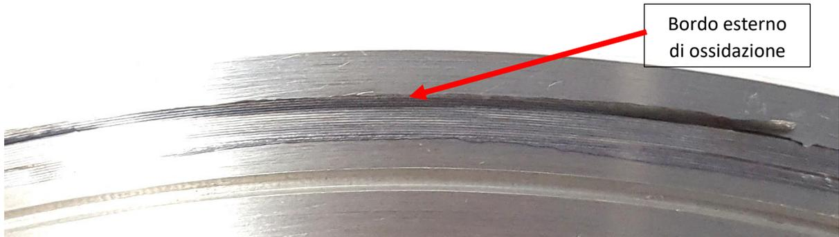
Fig. 4.50. Lungo il bordo esterno della guarnizione si è formata una striscia uniforme di ossidazione spessa circa 0,64.
