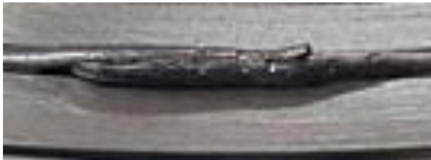
Fig. 4.21. Ingrandimento 6X della giunzione inclinata e sovrapposta su un piano perpendicolare alla superficie della flangia.
