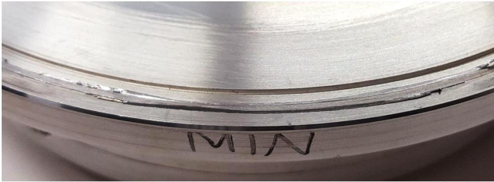
Fig. 4.42. Nelle foto sono indicate due zone dove la guarnizione risultava essere rispettivamente più larga e più stretta ogni volta che si richiudeva la flangia con nuove guarnizioni.
