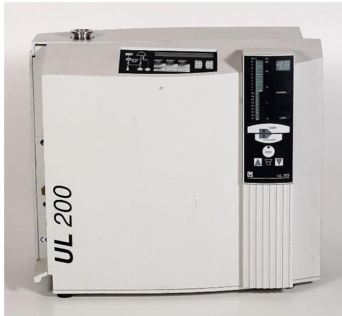
Fig. 4.14. Leak detector INFICON UL 200 utilizzato per rilevare il tasso di perdita delle guarnizioni in piombo.
