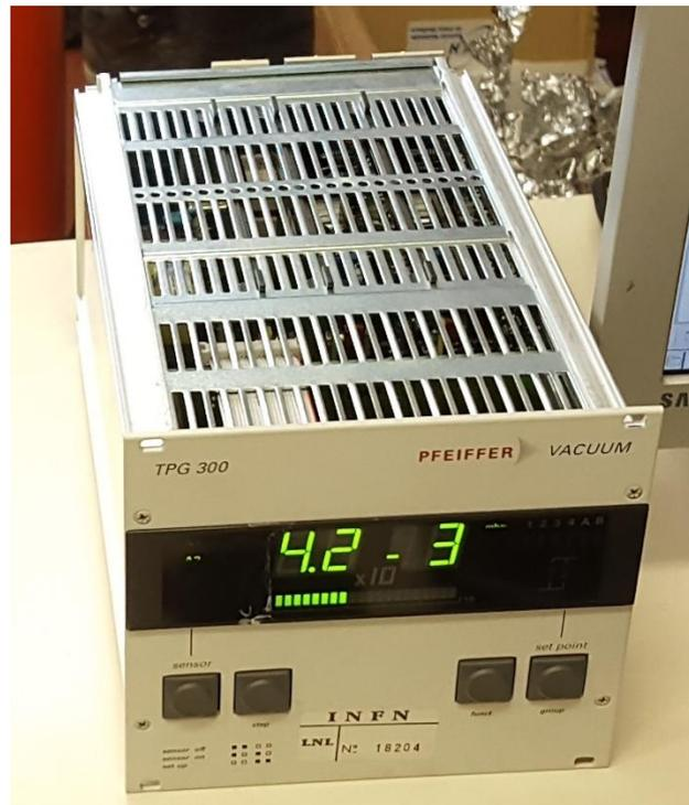
Fig.4.10. Centralina acquisizioni segnali sensori di pressione TPG 300 della PFEIFFER.
