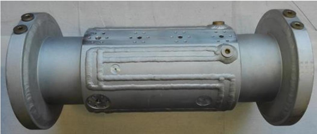
*Fig. 6.5: Collimatore già realizzato e pronto per l'installazione.*
