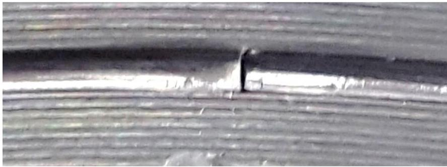
Fig. 4.23. Ingrandimento 6X della giunzione testa a testa.
