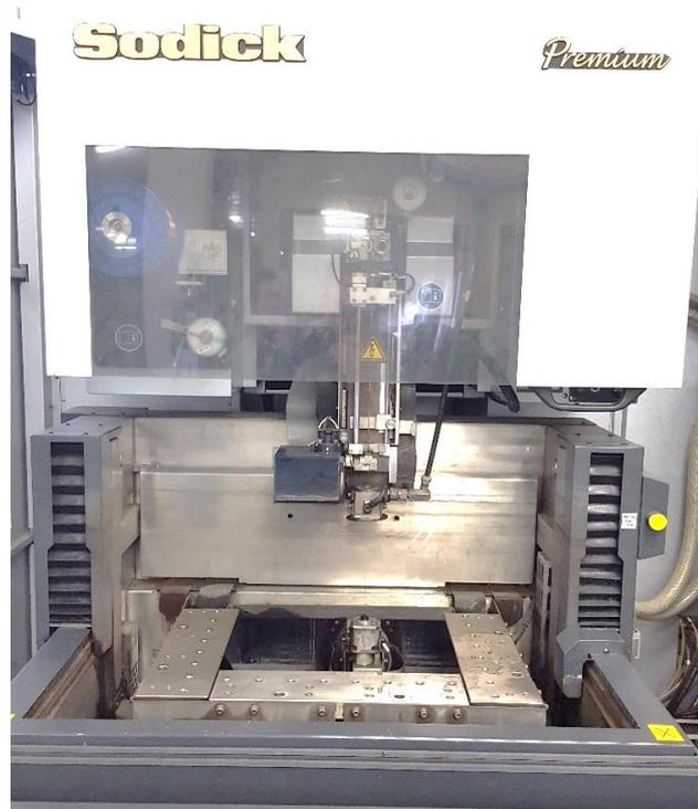
Fig.3.6. Macchina da elettroerosione utilizzata per dividere in due il disco per ottenere le due flange riscaldanti.
