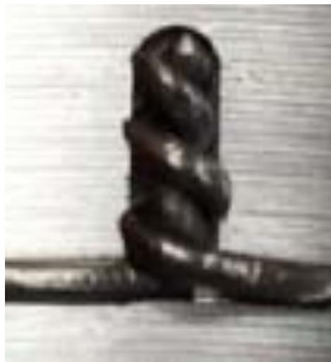
Fig. 4.24. Ingrandimento 7X della giunzione attorcigliata.
