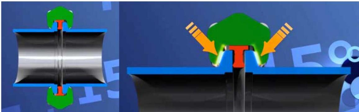
Fig.3.8. Principio di funzionamento di una connessione mediante morsetto a catena (chain clamp).
