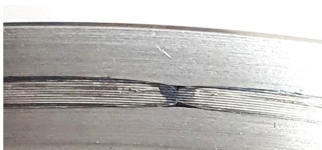
Fig. 4.41. Giunzione testa a testa ottenuta applicando la coppia 8,1 Nm con caratteristici segni di ossidazione indice del passaggio di aria
