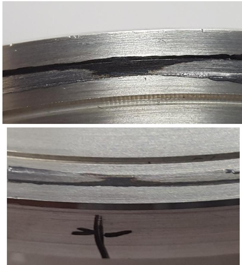
Fig. 4.51. In alcuni punti l'ossidazione è penetrata all'interno. Inoltre questi punti si sono ripetuti per entrambe le prove nelle stesse posizioni.
