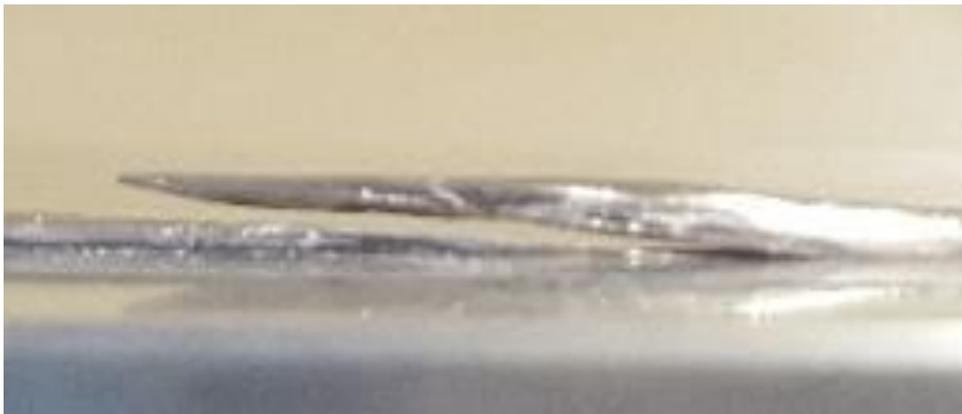
Fig. 4.22. Ingrandimento 6X della giunzione inclinata e sovrapposta su un piano parallelo alla superficie della flangia.
