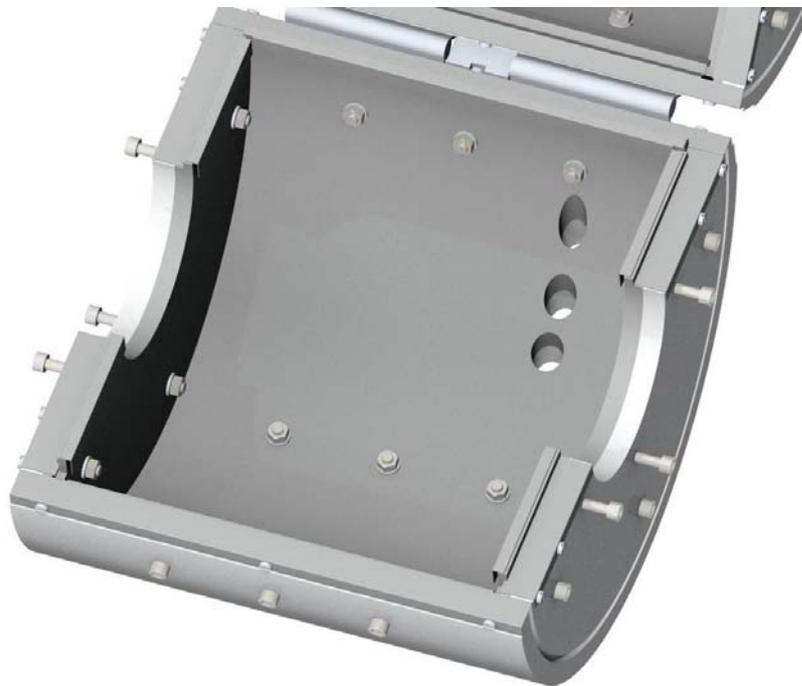
Fig. 6.29: Fori di passaggio tubi realizzati nella protezione in piombo. I tre fori sono rivolti in basso per evitare di dirigere le radiazioni contro gli operatori.
