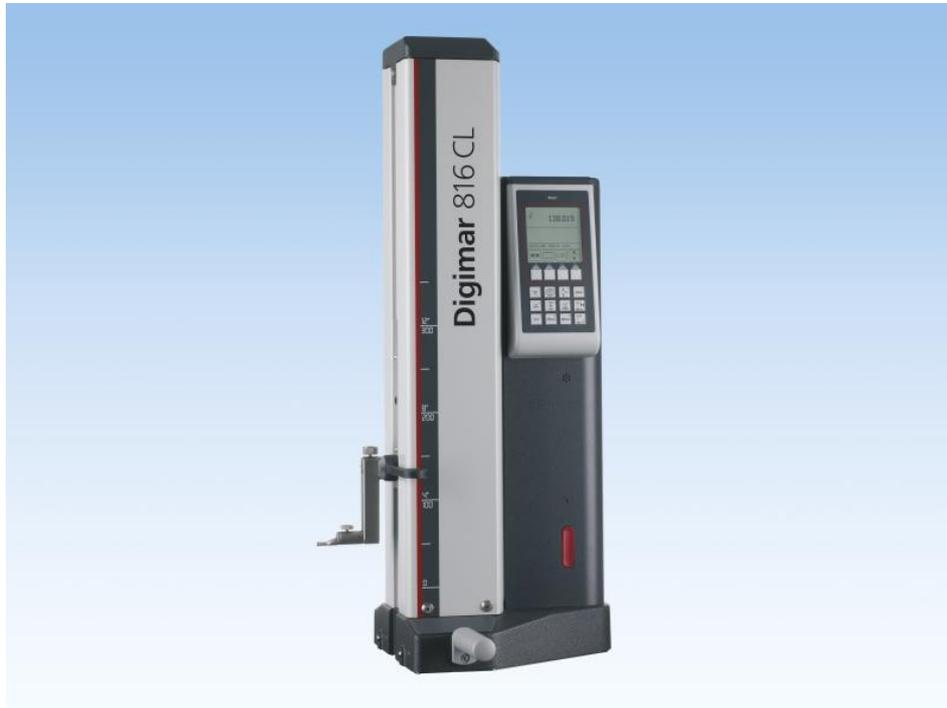
Fig. 4.13. Altimetro digitale DIGIMAR 816 CL usato per la misurazione della profondità delle cave per i wire ring di piombo.
