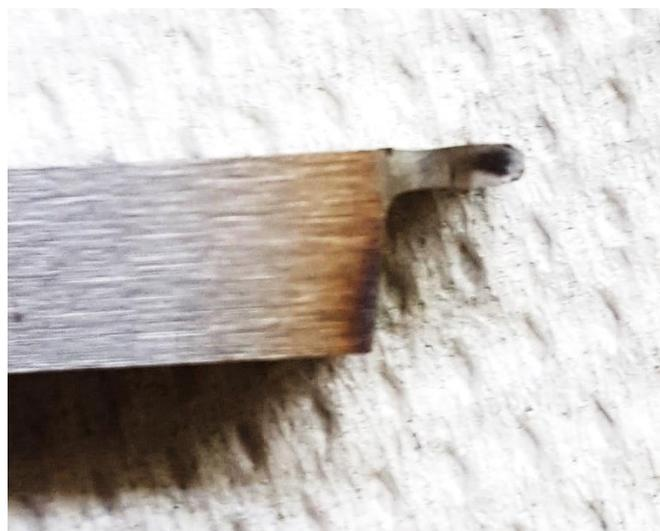
Fig. 3.32. Utensile sagomato utilizzato per la realizzazione delle cave.
