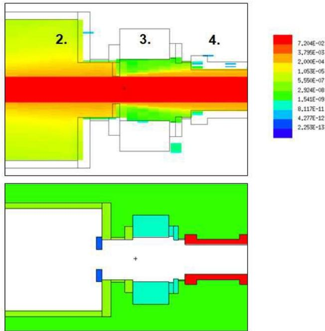
Fig.6.50: Soluzione adottata in (1) per ridurre l'attivazione della VAT è l'installazione di un disco in grafite (di colore blu all'interno della box). Allontanando questo disco il rischio di divergenza del fascio (visibile nella figura soprastante di colore rosso) comporta un aumento del rischio di attivazione della VAT.
