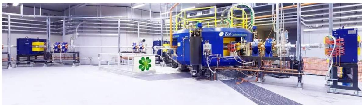
Fig. 1.7: Ciclotrone installato all'interno della facility SPES.
