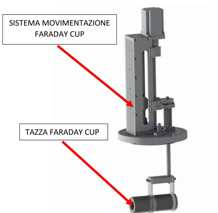
Fig. 6.9: Faraday cup inserita nel sistema di movimentazione pneumatico.
