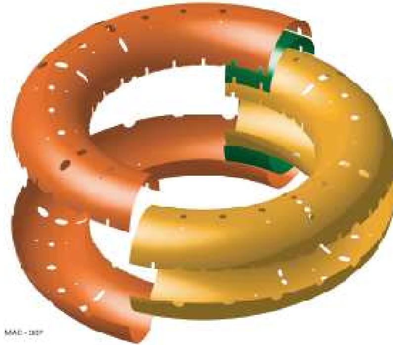
Figura 3-5: Scocca stabilizzante in rame della macchina RFX-mod
