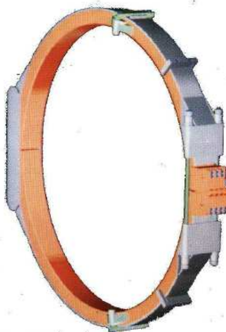
Figura 3-8: Rappresentazione tridimensionale di un singolo avvolgimento toroidale nella macchina RFX-mod
