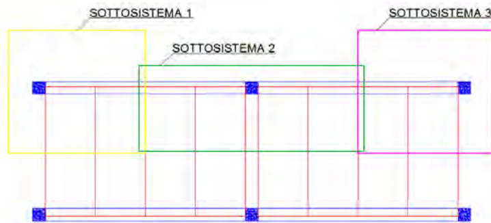
Figura 2.4: In caso di copertura deformabile, il sistema originario può essere studiato suddividendolo in una serie di sottosistemi, considerabili in prima approssimazione separatamente. In presenza di simmetria di geometria e carichi, il numero di sottosistemi utilizzato per descrivere il comportamento globale può essere ridotto.
