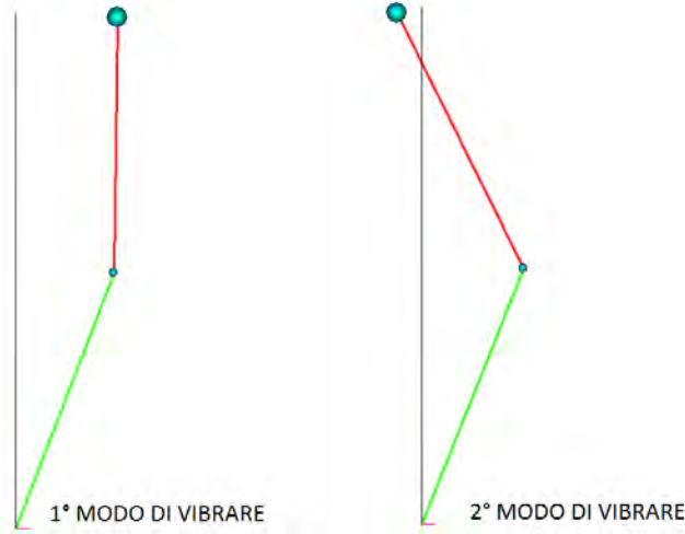
Figura 2.6: Modi principali di vibrare per un sistema a due gradi di libertà dinamici in serie.
